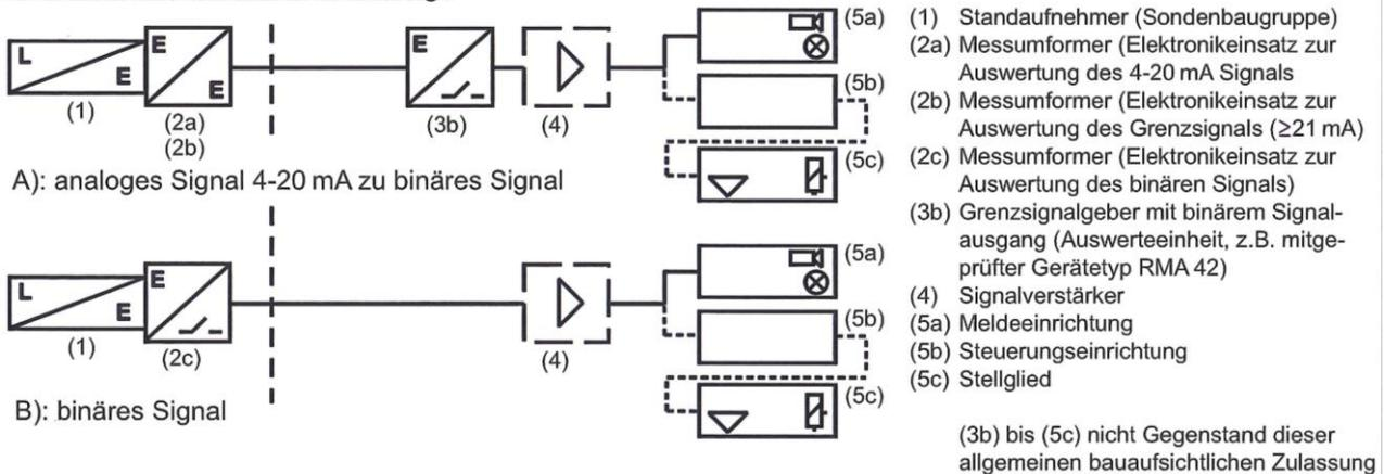
Standaufnehmer (Radar-Antenne) "Micropilot NMR8..." mit integriertem Messumformer als kontinuierliche Standmesseinrichtung von Überfüllsicherungen
