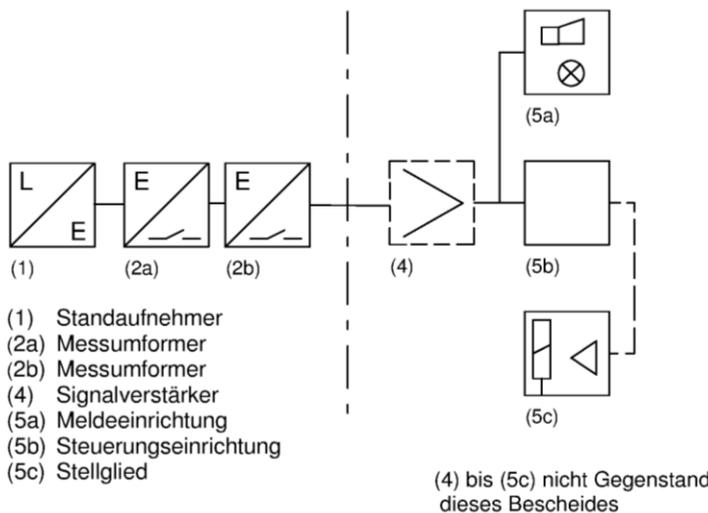
Leckagesonde (Schwimmer) Typ "T200L" und Messumformer als Teile von Leckageerkennungssystemen
