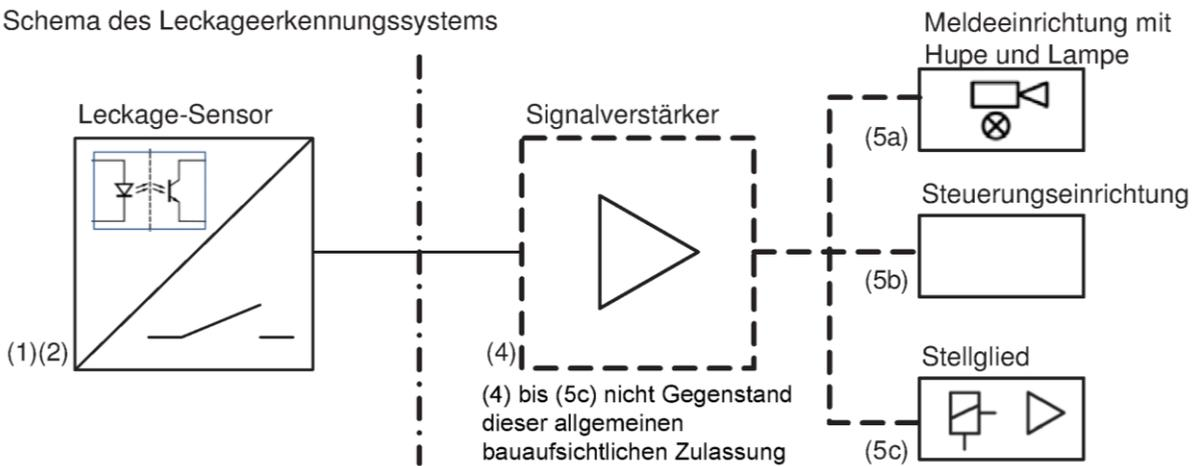
Photoelektrische Leckagesonde mit integriertem Messumformer als Teil von Leckageerkennungssystemen "Azbil HPQ-D"
