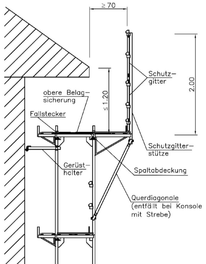
Beim Dachfanggerüst wird die Schutzgitterstütze als oberer Gerüstabschluss in Abhängigkeit von der Größe des Traufenüberstandes entweder auf dem Vertikalrahmen oder auf der Konsole 73 angeordnet.
