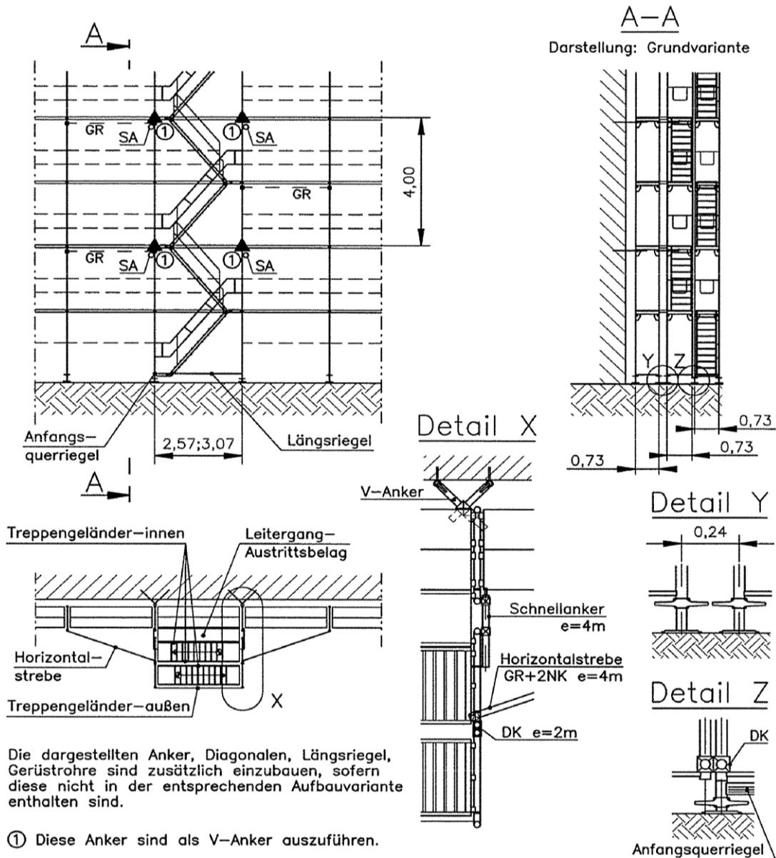
Die dargestellten Anker, Diagonalen, Längsriegel, Gerüstrohre sind zusätzlich einzubauen, sofern diese nicht in der entsprechenden Aufbauvariante enthalten sind.
