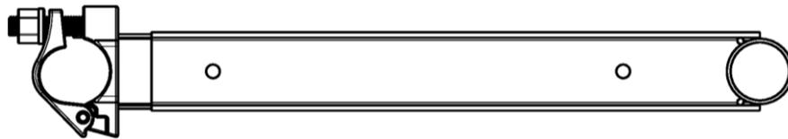
Feuerverzinkung nach DIN EN ISO 1461 (mind. 60µm)
