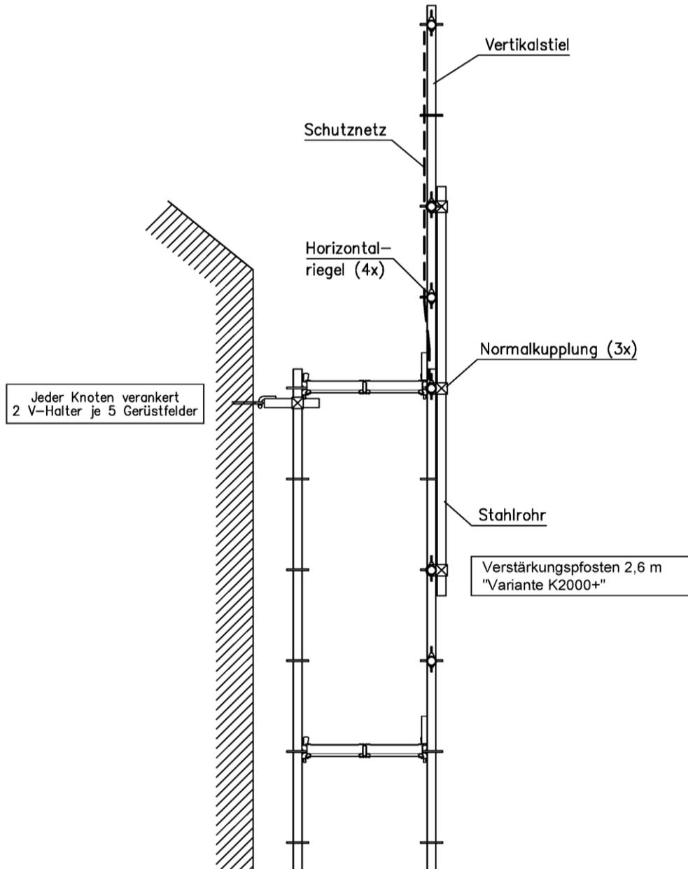
Schutznetz: DIN EN 1263-1, Maschenweite 100 mm
