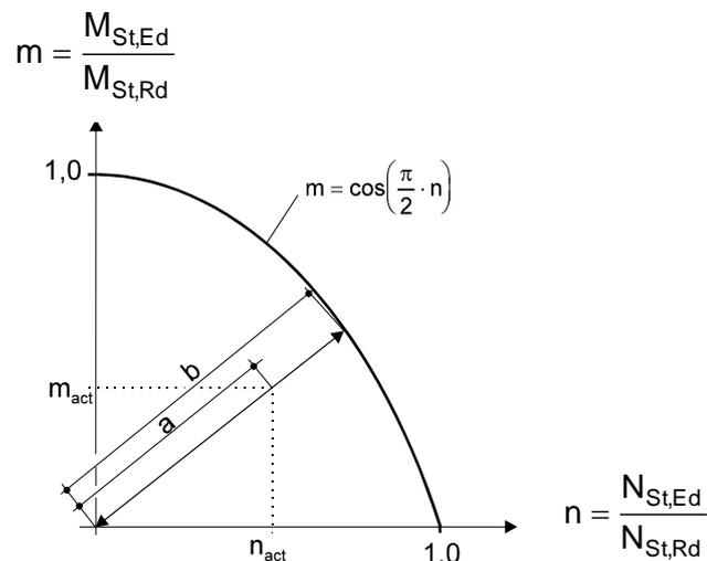
**Bild 1:** Vektorieller Ausnutzungsgrad im Ständerrohr
