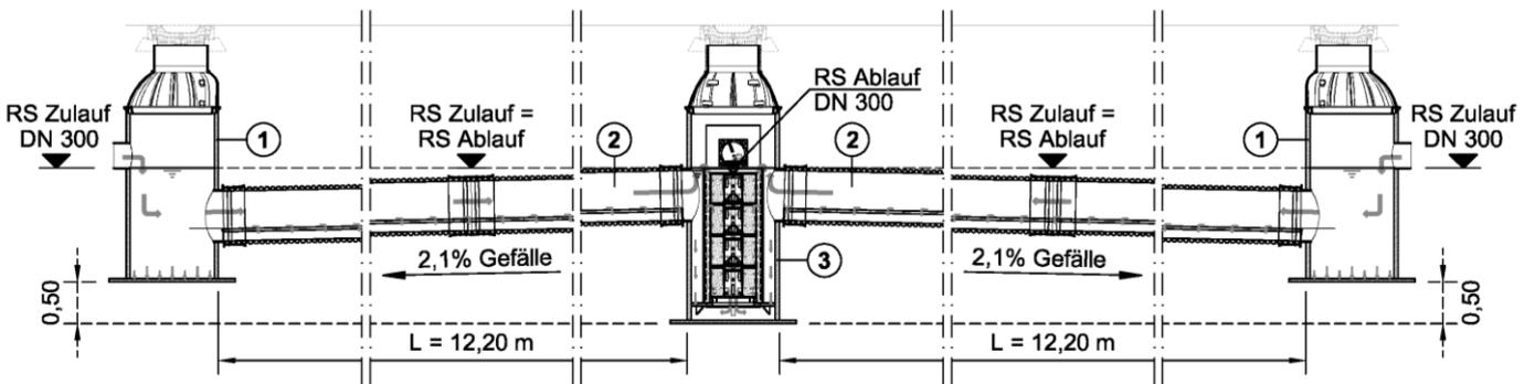
Anlagen zur Behandlung von mineralöhlhaltigen Niederschlagsabflüssen für die Versickerung SediSubstrator XL
