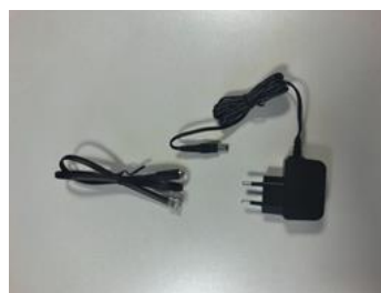
Spannungsversorgung des Grundgerätes mittels Steckernetzteil oder Busweiche
