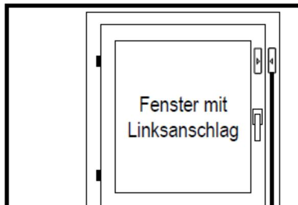
Positionierung Magnetschalter/Magnet am Fensterrahmen
