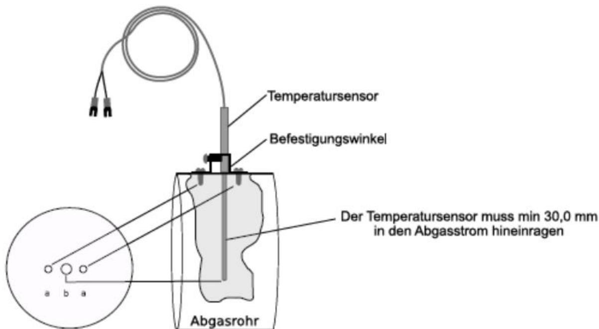
a = Bohrung für Schrauben d = 2,0 mm
