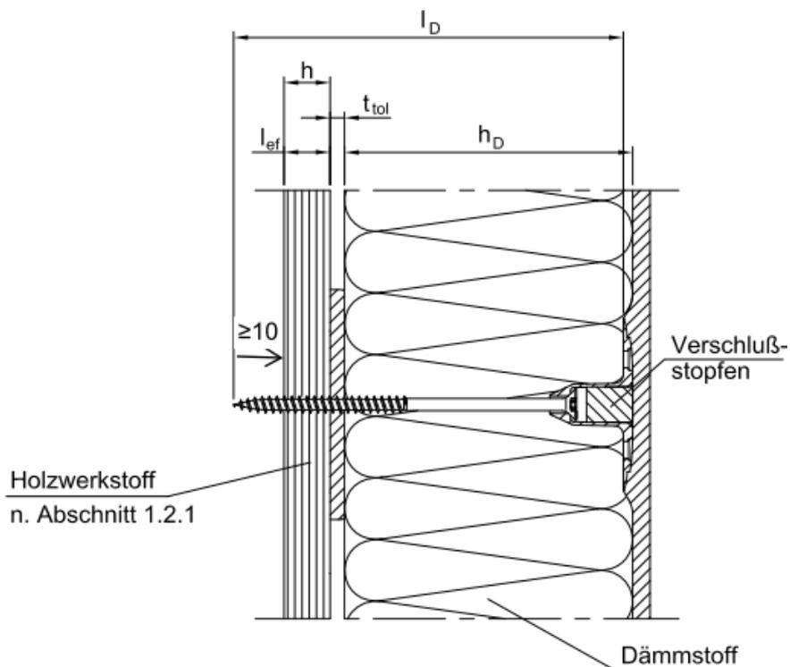
Schraubdübel ejotherm STR H A2, STR H E und STR H zur Befestigung von Wärmedämm-Verbundsystemen auf Außenwänden in Holzbauart
