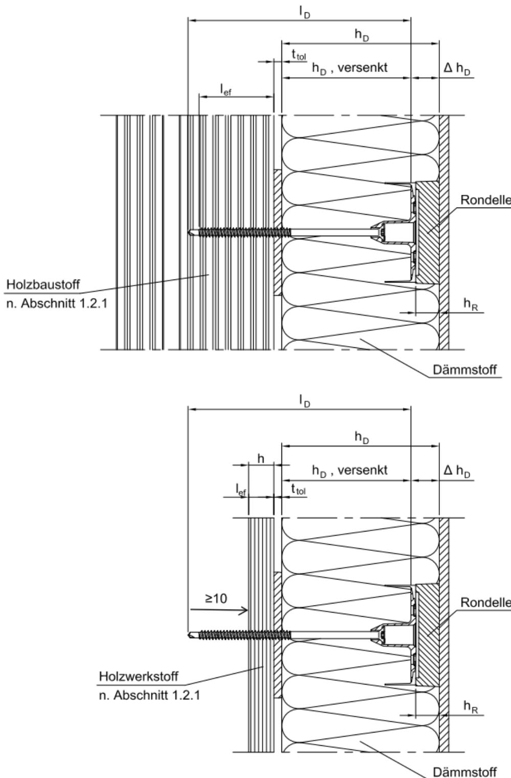
Schraubdübel ejotherm STR H A2, STR H E und STR H zur Befestigung
