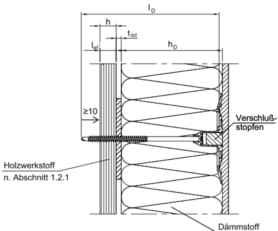
Schraubdübel ejotherm STR H A2, STR H E und STR H zur Befestigung
