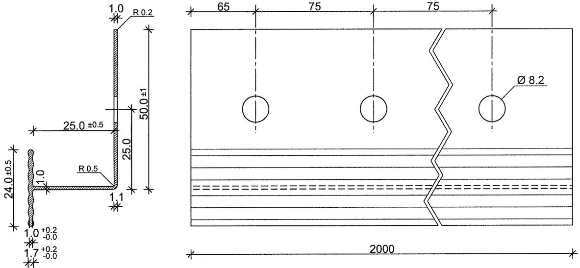
**Vertikales Verbindungsprofil – "SAKRET Verbindungsleiste"**(Abmessungen in Millimetern)
