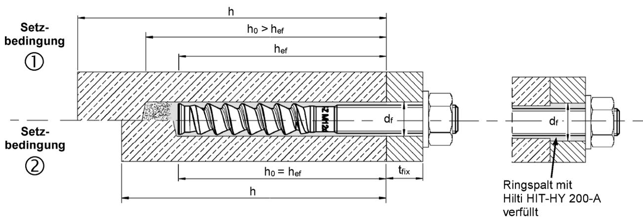
Setzbedingung ① → ungereinigtes Bohrloch
