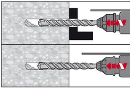
Durchsteckmontage: Bohrloch durch das Durchgangsloch im anzuschließenden Bauteil mit Bohrerhammer dreh Schlagend, unter Verwendung des passenden Bohrerdurchmessers auf die richtige Bohrtiefe erstellen.
