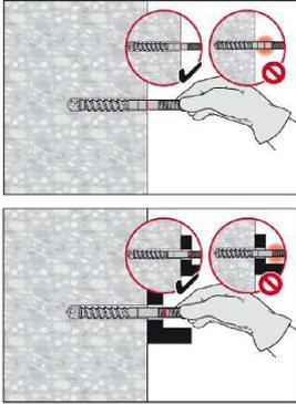
Befestigungselement markieren und Setztiefe kontrollieren. Die Ankerstange muss bis zur Setztiefenmarkierung in das Bohrloch passen.
