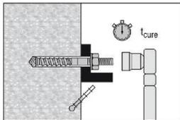
Nach Ablauf der erforderlichen Aushärtezeit  $t_{cure}$  (siehe Tabelle B4) kann der überstehende Mörtel entfernt und das erforderliche Installationsdrehmoment  $T_{inst}$  (siehe Tabelle B1) aufgebracht werden. Anschließend kann der Anker belastet werden.
