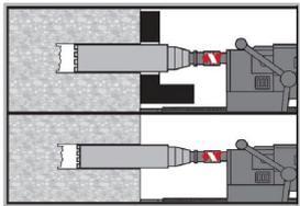
Diamantbohren ist zulässig, wenn geeignete Diamantbohrmaschinen und zugehörige Bohrkronen verwendet werden.
