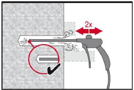
Bohrloch 2-mal mit ölfreier Druckluft (min. 6 bar bei 6m<sup>3</sup>/h; falls notwendig mit Verlängerung) ausblasen, um das Wasser zu entfernen.
