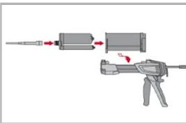
Statikmischer HIT-RE-M fest auf Foliengebinde aufschrauben. Den Mischer unter keinen Umständen verändern.
