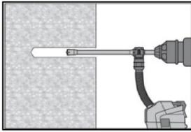
Vorsteck-/ Durchsteckmontage: Bohrloch mit Bohrerhammer dreh Schlagend, unter Verwendung des passenden Hilti Bohrers TE-CD oder TE-YD mit Hilti Staubsaugeranschluss auf die richtige Bohrtiefe erstellen. Dieses Bohrsystem beseitigt das Bohrmehl und reinigt das Bohrloch während des Bohrvorgangs (siehe Anhang A1 - Setzbedingung ②).
