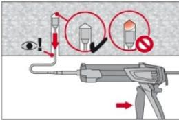
Das Injizieren des Mörtels bei Überkopfanwendung ist nur mit Hilfe von Stauzapfen und Verlängerungen möglich.
