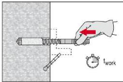
Vor der Montage sicherstellen, dass das Element trocken und frei von Öl und anderen Verunreinigungen ist. Element bis zur gewünschten Verankerungstiefe einführen, noch bevor die Verarbeitungszeit  $t_{work}$  (siehe Tabelle B4) abgelaufen ist. Nach dem Einsetzen des Befestigungselementes muss der Ringspalt zwischen Element und Anbauteil (Durchsteckmontage) oder Element und Beton (Vorsteckmontage) ausgefüllt sein.
