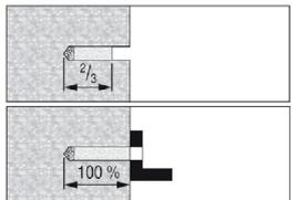
Vorsteckmontage: Das Bohrloch zu ca. 2/3 verfüllen.
