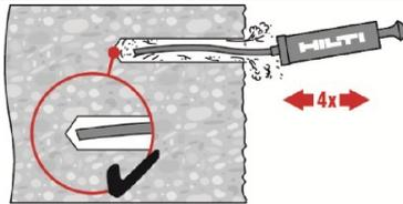
Für Bohrlochdurchmesser  $d_0 \leq 20$  mm und Verankerungstiefen  $h_{ef} \leq 10 \cdot \phi$ .
