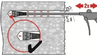
Entsprechende Luftdüse Hilti HIT-DL verwenden (siehe Tabelle B8). Bohrloch 2-mal vom Bohrlochgrund über die gesamte Länge mit ölfreier Druckluft ausblasen, bis die rückströmende Luft staubfrei ist.
