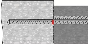
Die volle Belastung darf erst nach Ablauf der Aushärtezeit  $t_{cure}$  aufgebracht werden (siehe Tabelle B5).
