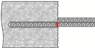
Verarbeitungszeit  $t_{work}$  beachten (siehe Tabelle B5), die je nach Temperatur des Verankerungsgrundes unterschiedlich ist. Während der Verarbeitungszeit ist ein geringfügiges Ausrichten des Betonstahls möglich.
