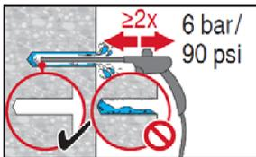
2-mal ausblasen mit ölfreier Druckluft (min. 6 bar bei  $6 \text{ m}^3/\text{h}$ ) über die gesamte Bohrlochtiefe vom Bohrlochgrund her (falls erforderlich mit Verlängerung), bis die rückströmende Luft frei von erkennbarem Staub ist. Vor dem Verfüllen mit Mörtel ist das Wasser aus dem Bohrloch zu entfernen, bis es vollständig trocken ist. Für Bohrlochdurchmesser  $\geq 32 \text{ mm}$  muss der Kompressor eine Mindest-Druckluftmenge von  $140 \text{ m}^3/\text{h}$  liefern.
