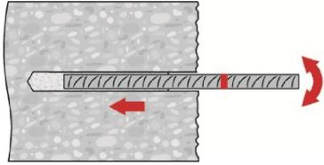
Zur Erleichterung der Installation den Betonstahl drehend in das verfüllte Bohrloch bis zur Setztiefenmarkierung einführen.
