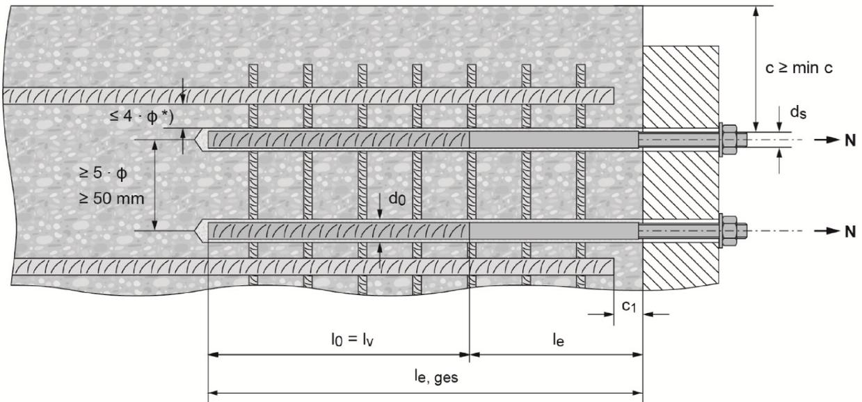
\*) Ist der lichte Abstand der gestoßenen Stäbe größer als  $4 \cdot \phi$ , so muss die Übergreifungslänge um die Differenz zwischen dem vorhandenen lichten Stababstand und  $4 \cdot \phi$  vergrößert werden.
