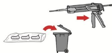
Das Öffnen der Foliengebinde erfolgt automatisch bei Auspressbeginn. Der am Anfang aus dem Mischer austretende Mörtelvorlauf darf nicht für Befestigungen verwendet werden. Die Menge des Mörtelvorlaufes ist abhängig von der Gebindegröße:
