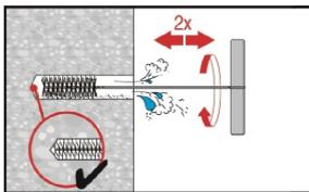
Bohrloch 2-mal ausbürsten mit spezifizierter Bürste (siehe Tabelle 10) durch Einführen der Stahlbürste Hilti HIT-RB mit einer Drehbewegung bis zum Bohrlochgrund (falls erforderlich mit Verlängerung) und wieder herausziehen. Die Bürste muss einen natürlichen Widerstand beim Einführen in das Bohrloch hervorrufen ( $\varnothing$  Bürste  $\geq$  Bohrloch  $\varnothing$ ) - falls nicht, ist die Bürste zu klein und muss durch eine Bürste mit passendem oder größerem Bürstendurchmesser ersetzt werden.
