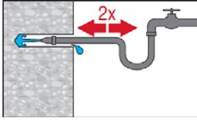
Bohrloch 2-mal ausspülen durch Einführen eines Wasserschlauches bis zum Bohrlochgrund, bis das herausströmende Wasser klar ist. Normaler Wasserleitungsdruck genügt.
