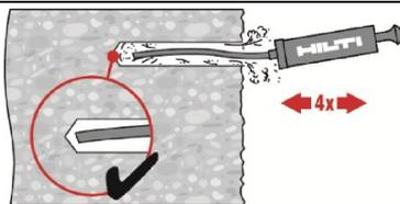
Bohrloch erneut mit der Hilti Handausblaspumpe vom Bohrlochgrund mindestens 4-mal ausblasen, bis die rückströmende Luft staubfrei ist.
