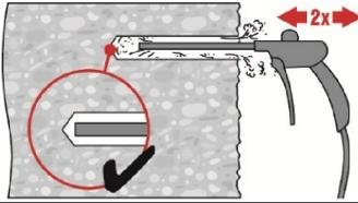
Bohrloch 2-mal vom Bohrlochgrund über die gesamte Länge mit ölfreier Druckluft (min. 6 bar bei  $6 \text{ m}^3/\text{h}$ ; falls notwendig mit Verlängerung) ausblasen, bis die rückströmende Luft staubfrei ist.
