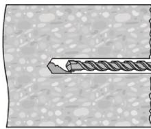
Die Bohrlocherstellung bis zur erforderlichen Setztiefe erfolgt dreh Schlagend mithilfe eines Bohrhammers oder mithilfe eines Pressluftbohrers unter Verwendung des passenden Bohrerdurchmessers.
