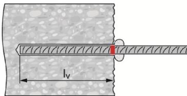
Nach der Montage des Betonstahls muss der Ringspalt vollständig mit Mörtel ausgefüllt sein.
