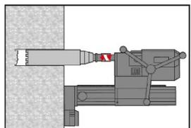
Diamantbohren ist zulässig, wenn passende Diamantbohrmaschinen und entsprechende Diamantkernbohrer verwendet werden
