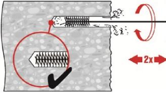
2-mal mit Stahlbürste in passender Größe (siehe Tabelle B8) bürsten. Stahlbürste Hilti HIT-RB mit einer Drehbewegung in das Bohrloch bis zum Bohrlochgrund einführen und wieder herausziehen (falls notwendig mit Verlängerung).
