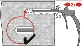
Bohrloch erneut vom Bohrlochgrund über die gesamte Länge 2-mal mit Druckluft ausblasen, bis die rückströmende Luft staubfrei ist.
