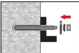
Verwendung des Hilti Verfüll-Sets mit Standardmutter. Korrekte Orientierung der Verschlusscheibe und der Kugelscheibe beachten.
