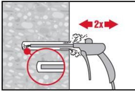
Bohrloch 2-mal vom Bohrlochgrund über die gesamte Länge mit ölfreier Druckluft (min. 6 bar bei 6 m<sup>3</sup>/h; falls notwendig mit Verlängerung) ausblasen, bis die rückströmende Luft staubfrei ist. Für Bohrlochdurchmesser  $\geq 32$  mm muss der Kompressor mindestens 140 m<sup>3</sup>/h Luftstrom haben.
