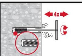
4-mal mit Stahlbürste in passender Größe (siehe Tabelle B8) bürsten. Stahlbürste Hilti HIT-RB mit einer Drehbewegung in das Bohrloch bis zum Bohrlochgrund einführen und wieder herausziehen (falls notwendig mit Verlängerung). Die Bürste muss beim Einführen einen Widerstand erzeugen (Bürsten  $\varnothing \geq$  Bohrloch  $\varnothing$ ) - falls nicht, ist die Bürste zu klein und muss durch eine größere Bürste ersetzt werden.
