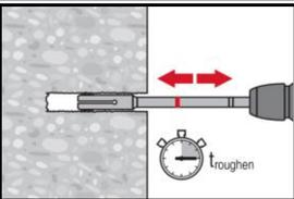
Vor dem Aufrauen muss das Wasser aus dem Bohrloch entfernt werden. Verwendbarkeit des Aufrauwerkzeugs mit der Abnutzungslehre RTG prüfen. Das Bohrloch über die gesamte Bohrtiefe bis zur geforderten Verankerungstiefe  $h_{ef}$  aufrauen.
