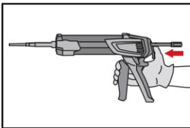
Nach der Mörtelinjektion die Entriegelungstaste am Auspressgerät betätigen, um Mörtelnachlauf zu vermeiden.
