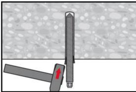
Bei Überkopfanwendung das Element in seiner endgültigen Position z.B. mittels Keile (Hilti HIT-OHW), gegen Herausrutschen sichern.
