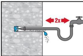
Das Bohrloch 2 mal mittels Wasser mit einem Schlauch vom Bohrlochgrund spülen, bis klares Wasser aus dem Bohrloch austritt. Normaler Wasserleitungsdruck genügt.
