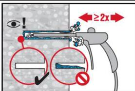
Bohrloch 2-mal vom Bohrlochgrund über die gesamte Länge mit ölfreier Druckluft (min. 6 bar bei 6 m<sup>3</sup>/h; falls notwendig mit Verlängerung) ausblasen, bis die rückströmende Luft staubfrei und das Bohrloch trocken ist. Vor dem Verfüllen mit Mörtel das Wasser vollständig aus dem Bohrloch entfernen bis das Bohrloch vollständig trocken ist. Für Bohrlochdurchmesser  $\geq 32$  mm muss der Kompressor mindestens 140 m<sup>3</sup>/h Luftstrom haben.
