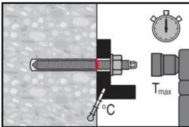
Last bzw. Drehmoment aufbringen: Nach Ablauf der Aushärtezeit  $t_{cure}$  (siehe Tabelle B7) kann der Anker belastet werden.
