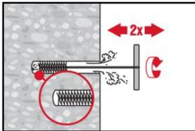
2-mal mit Stahlbürste in passender Größe (siehe Tabelle B8) bürsten. Stahlbürste Hilti HIT-RB mit einer Drehbewegung in das Bohrloch bis zum Bohrlochgrund einführen und wieder herausziehen (falls notwendig mit Verlängerung). Die Bürste muss beim Einführen einen Widerstand erzeugen (Bürsten  $\varnothing \geq$  Bohrloch  $\varnothing$ ) - falls nicht, ist die Bürste zu klein und muss durch eine größere Bürste ersetzt werden.
