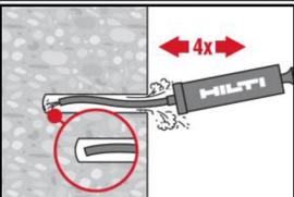
Für Bohrdurchmesser  $d_0 \leq 20$  mm und Verankerungstiefen  $h_{ef} \leq 10 \cdot d$ . Das Bohrloch mindestens 4-mal mit der Hilti Ausblaspumpe vom Bohrlochgrund ausblasen, bis die rückströmende Luft staubfrei ist.
