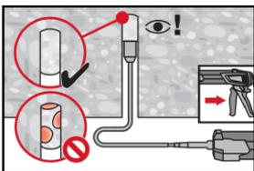
Überkopfanwendung und/oder Montage bei Verankerungstiefen von  $h_{ef} > 250$ mm. Das Injizieren des Mörtels bei Überkopfanwendung ist nur mit Hilfe von Stauzapfen und Verlängerungen möglich.
