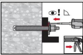
Ringspalt zwischen Ankerstange und Anbauteil mit Hilti Injektionsmörtel HIT-HY 200 R mit 1 bis 3 Hüben verfüllen.
