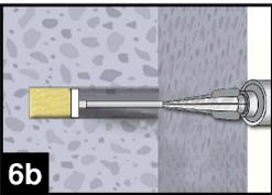
Für die Horizontal- oder Überkopfmontage, sowie bei Bohrlöchern tiefer als 240mm sind Verfüllstutzen zu verwenden.
