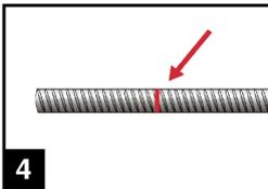
4. Vor dem Injizieren des Mörtels ist die Setztiefe auf dem Bewehrungsstab zu markieren (z.B. mit Klebeband). Danach den Bewehrungsstab in das leere Bohrloch einführen, um die korrekte Bohrlochtiefe  $l_v$  zu überprüfen. Der Bewehrungsstab sollte schmutz-, fett-, und ölfrei sein.
