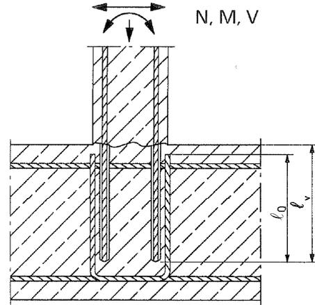
**Bild A3:** Endverankerung von Platten oder Balken
