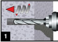
1. Bohrloch mit dem Durchmesser und der Bohrlochtiefe entsprechend des gewählten Bewehrungsseisens mit Hammerbohrer (HD), Hohlbohrer (HDB) oder Druckluftbohrer (CD) in den Untergrund bohren. Bei Fehlbohrungen ist das Bohrloch zu vermörteln.
