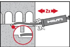
Bohrloch mindestens 2-mal mit der Hilti Ausblaspumpe vom Bohrlochgrund ausblasen bis die rückströmende Luft staubfrei ist.
