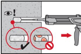
Injizieren des Mörtels vom Bohrlochgrund und während jedes Hubes den Mischer zurückziehen.
