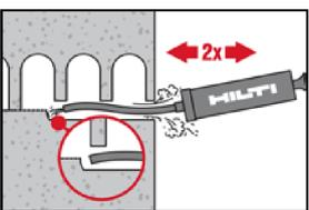
Bohrloch erneut mit der Hilti Handausblaspumpe vom Bohrlochgrund mindestens 2-mal ausblasen bis die rückströmende Luft staubfrei ist.
