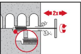
2-mal mit Stahlbürste in passender Größe (siehe Tabelle B5 bis Tabelle B8) bürsten. Stahlbürste Hilti HIT-RB mit einer Drehbewegung in das Bohrloch bis zum Bohrlochgrund einführen und wieder herausziehen. Die Bürste muss beim Einführen einen Widerstand erzeugen (Bürste  $\varnothing \geq$  Bohrloch  $\varnothing$ ) – falls nicht, ist die Bürste zu klein und muss durch eine geeignete Bürste ersetzt werden.
