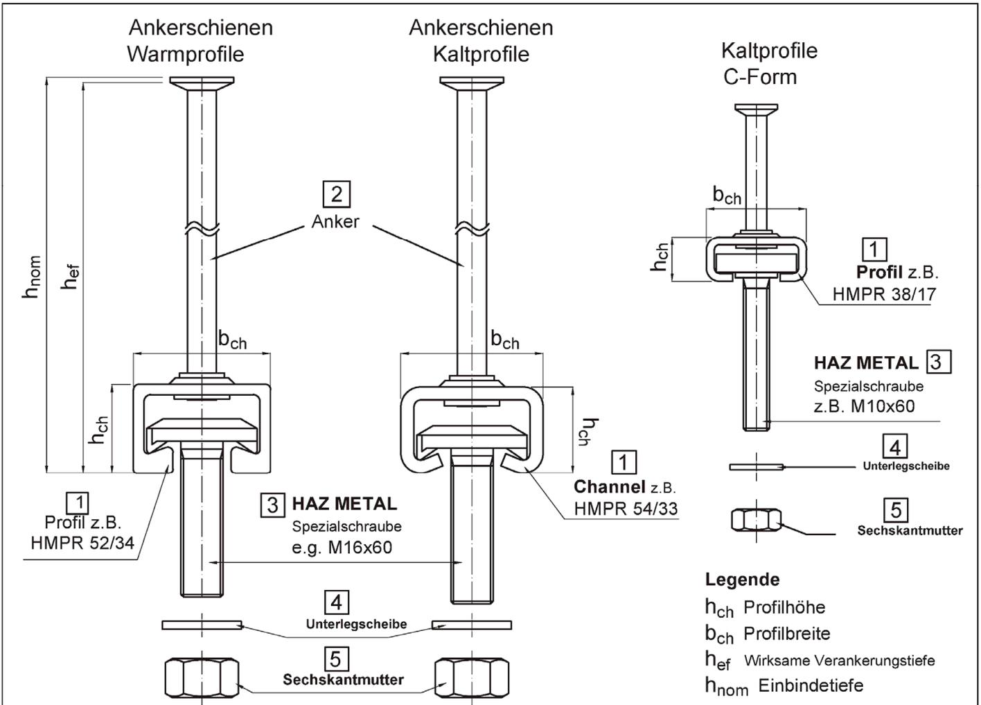
**Kennzeichnung der HAZ Ankerschiene
