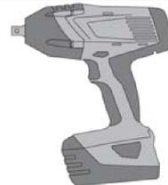
Einbau der Betonschraube mit Tangential-Schlagschrauber.
