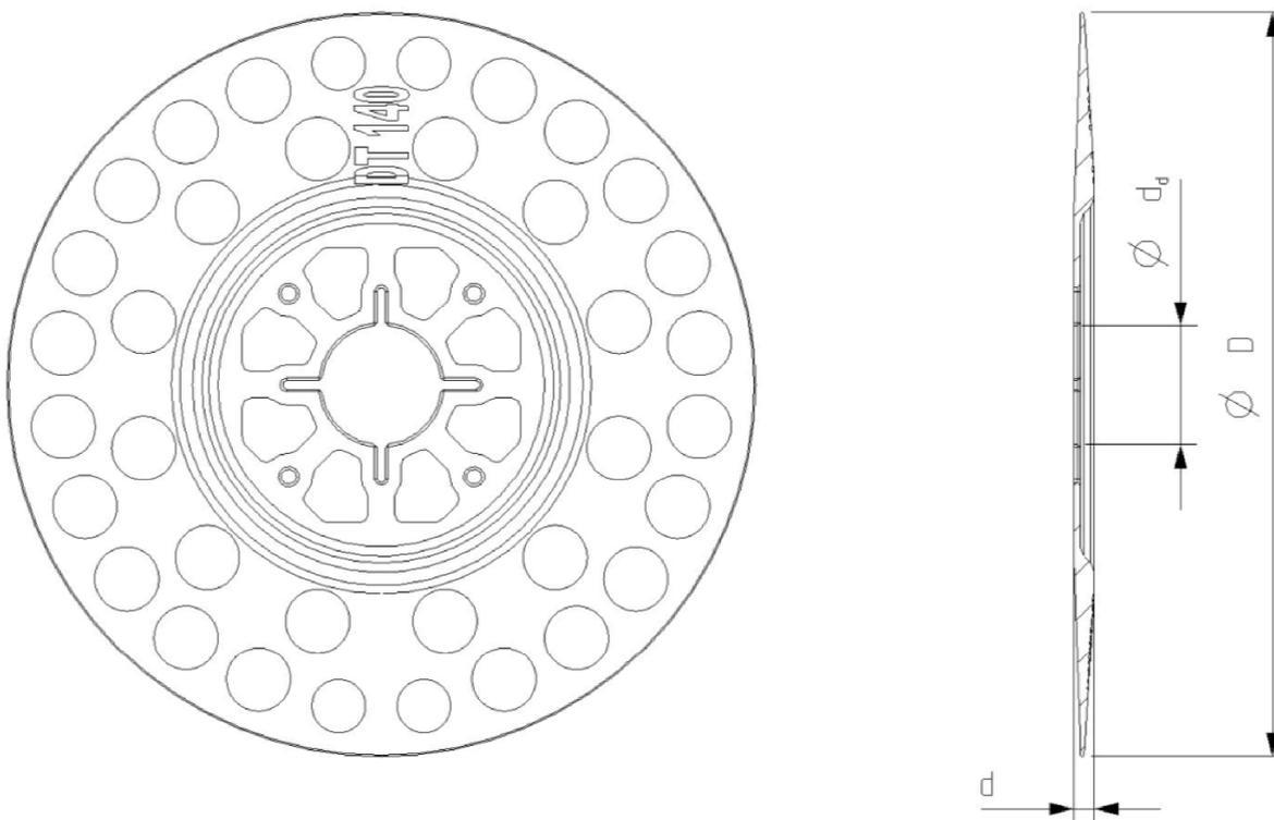
**Tabelle A3.2 Dübelteller, Abmessungen und Werkstoff**
