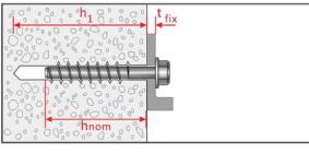
Hexagon Head : SK-H, SK-HF 10B21 (SK8, SK10, SK12) A4 (SK8, SK10, SK12)
