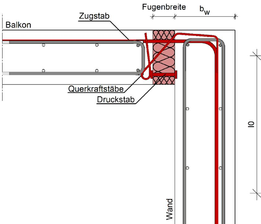
Abbildung A - 20 Egibox Typ WO – Anschluss am Wandkopf – Querkraftstab mit Schlaufe
