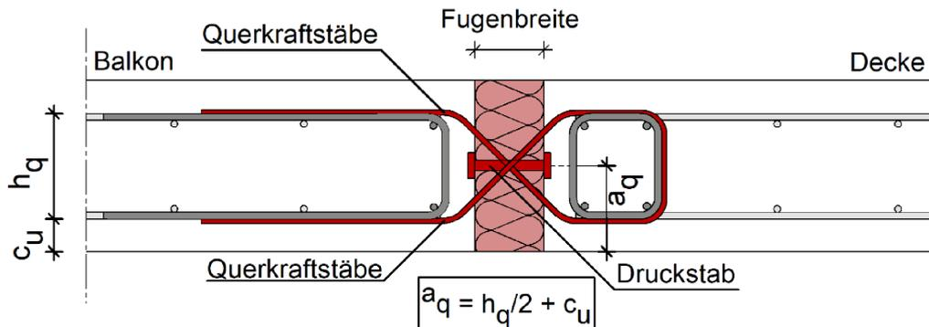
Abbildung A - 12 Egccobox Typ V± – Querkraftanschluss zu Übertragung von positiven und negativen Querkraften und mittigem Drucklager und bauseitigem Randbalken
