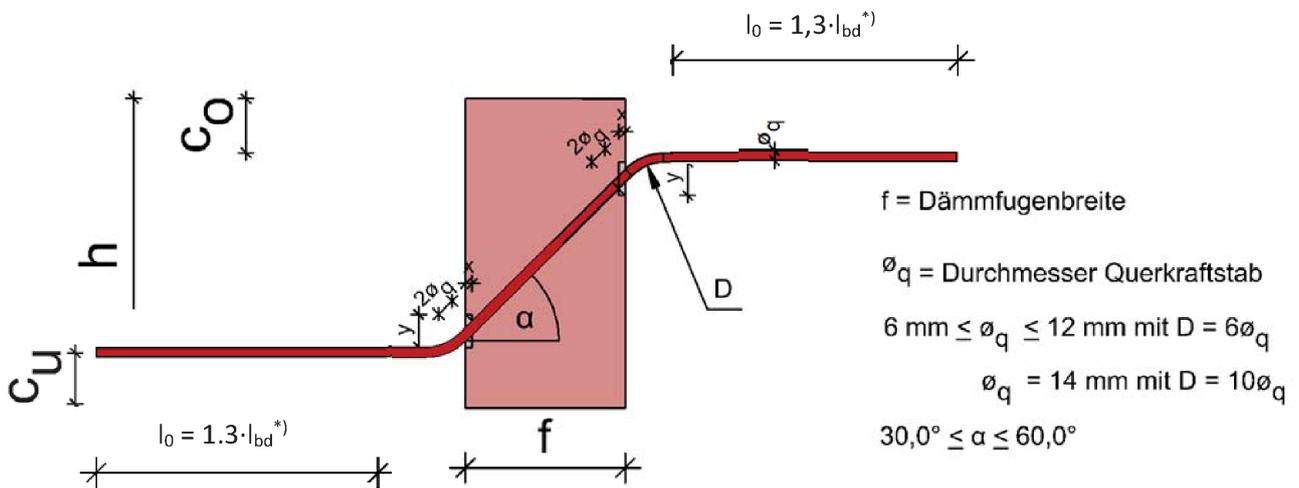
Abbildung A - 26 Ausführung Querkraftstab
