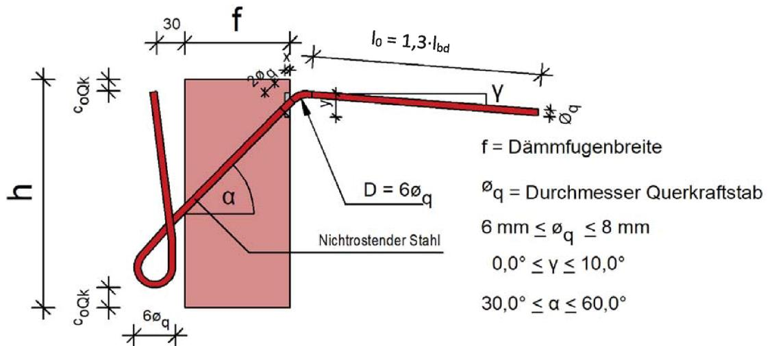
Abbildung A - 25 Ausführung Querkraftstab mit Schlaufe
