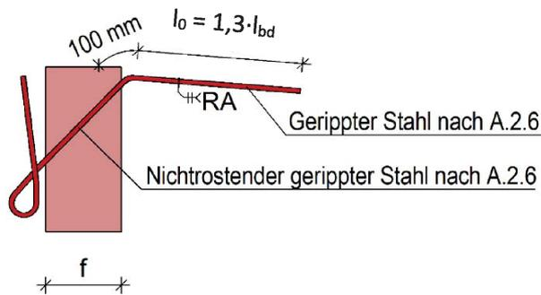
Abbildung A - 36 Querkraftstabvariante 2 – Schleufe stumpfgeschweißt
