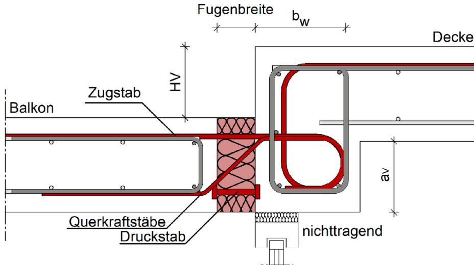
Abbildung A - 13 Egco box Typ HV mit Höhenversatz des getragenen Bauteils nach unten
