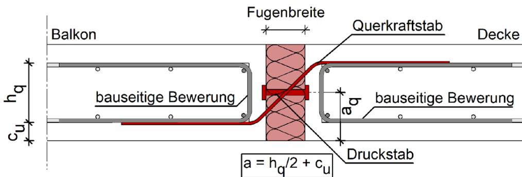
Abbildung A - 6 Egcoibox Typ V – Querkraftanschluss mit mittigem Drucklager
