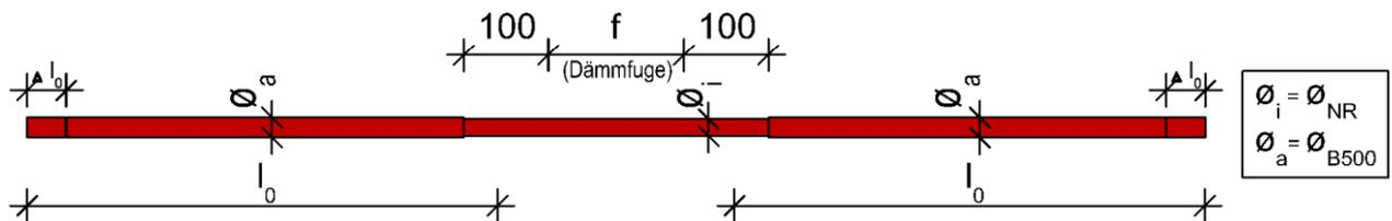
Abbildung C - 1 Übergreifungslänge Zugstab
