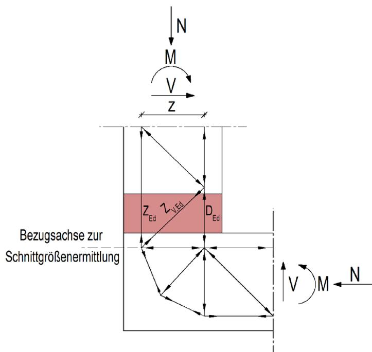
Abbildung D - 11 Egccobox Typ A – Attika – Momenten-, Querkraft- und Normalkraftanschluss
