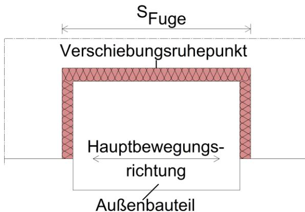
Abbildung B - 2 Zwängungsfreie Lagerung bei gegenüberliegenden Anschlüssen
