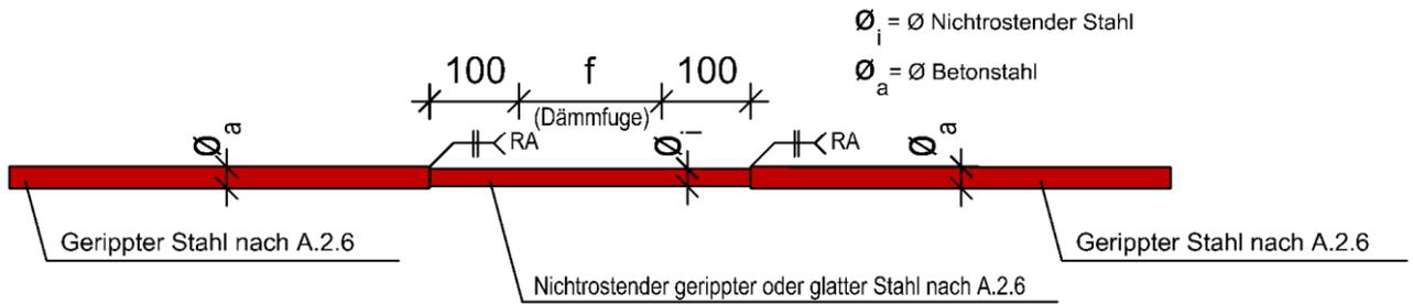
Abbildung A - 31 Druckstabvariante 2 – stumpfgeschweißt
