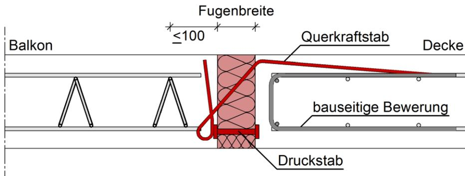
Abbildung A - 5 Egcoibox Typ V – Querkraftanschluss – Querkraftstab mit Schlaufe und bauseitigem Gitterträger
