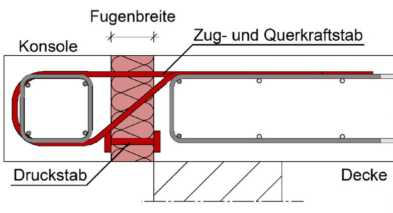
Abbildung A - 24 Egccobox Typ O – Konsole – Momenten-, Querkraft- und Normalkraftanschluss – mit Drucklager
