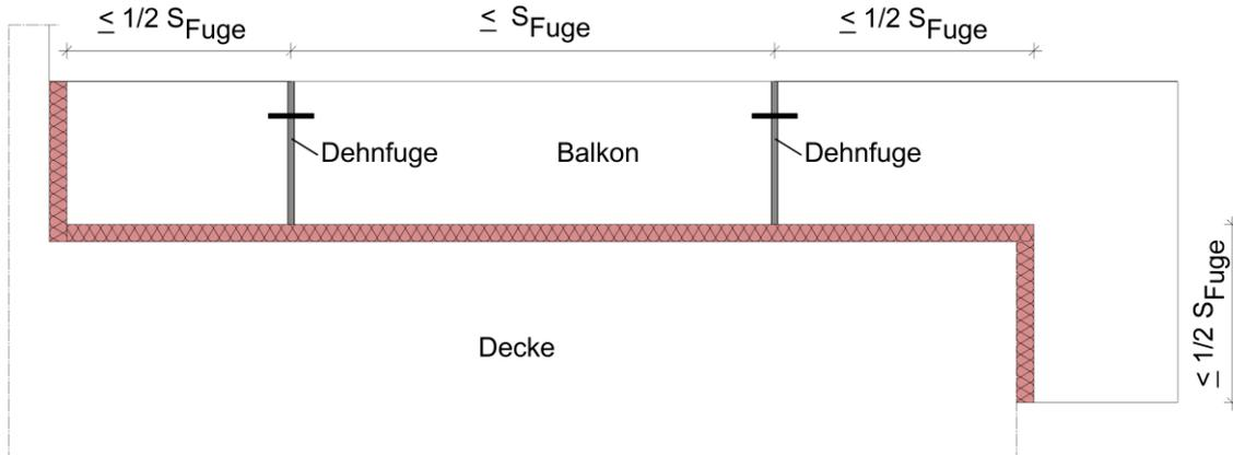
Abbildung B - 1 Dehnfugenabstände in den Außenbauteilen
