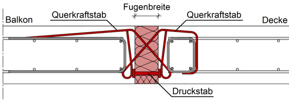
Abbildung A - 11 Egccobox Typ V± – Querkraftanschluss zu Übertragung von positiven und negativen Querkraften – Querkraftstab mit Schlaufe und bauseitigem Randbalken
