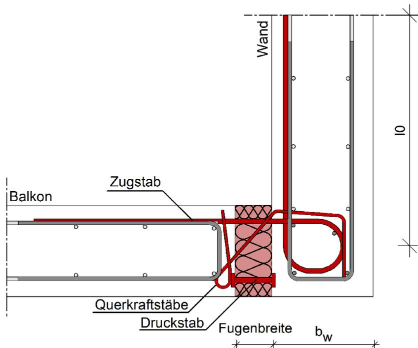
Abbildung A - 17 Egco box Typ WO – Anschluss am Wandfuß
