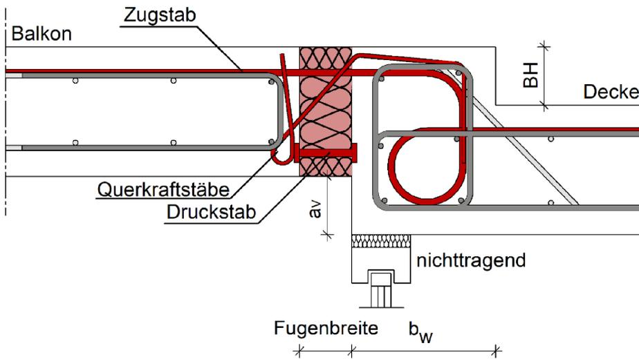
Abbildung A - 16 Egibox Typ BH mit Höhenversatz des getragenen Bauteils nach oben –
