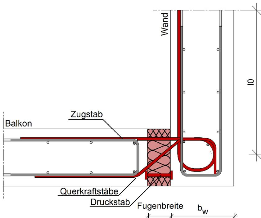
Abbildung A - 18 Egco box Typ WO – Anschluss am Wandfuß – Querkraftstab mit Schlaufe
