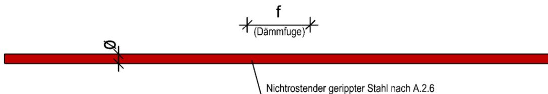
Abbildung A - 28 Zugstabvariante 1 – nichtrostender Stahl
