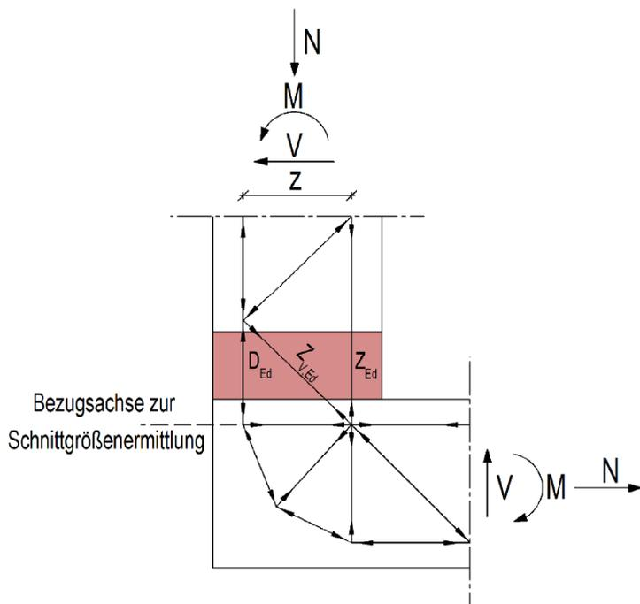
Abbildung D - 10 Egccobox Typ A – Attika – Momenten-, Querkraft- und Normalkraftanschluss
