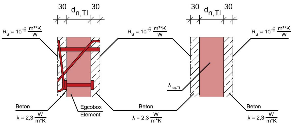
Abbildung C - 8 Querschnitt der Konstruktion zur Bestimmung des äquivalenten Wärmedurchlasswiderstandes  $R_{eq,TI}$  sowie des vereinfachten Modells mit  $\lambda_{eq,TI}$
