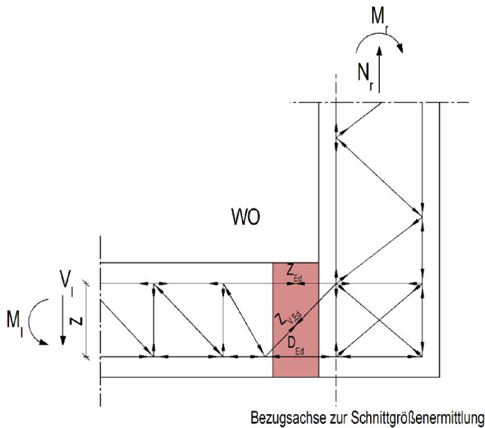
Abbildung D - 9 Egcobox WO - Momenten- und Querkraftanschluss an den Wandfuß – statisches System
