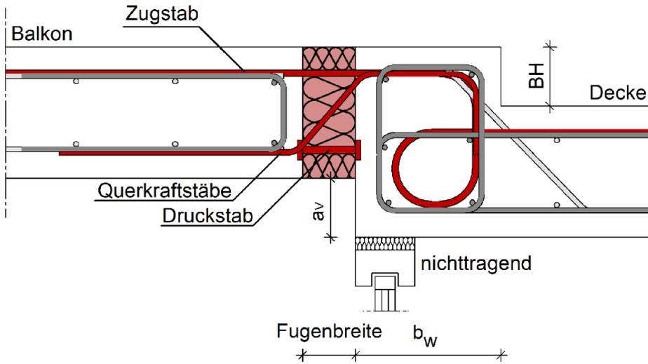
Abbildung A - 15 Egibox Typ BH mit Höhenversatz des getragenen Bauteils nach oben
