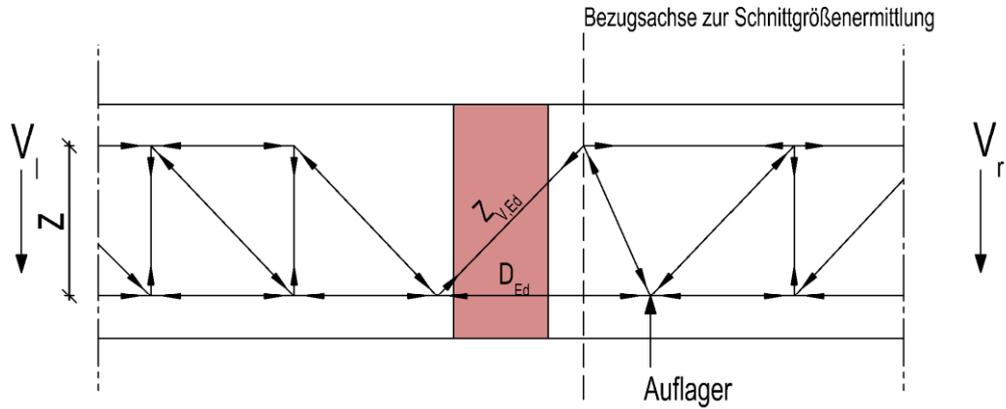
Abbildung D - 4 Egccobox V - Querkraftanschluss – statisches System
