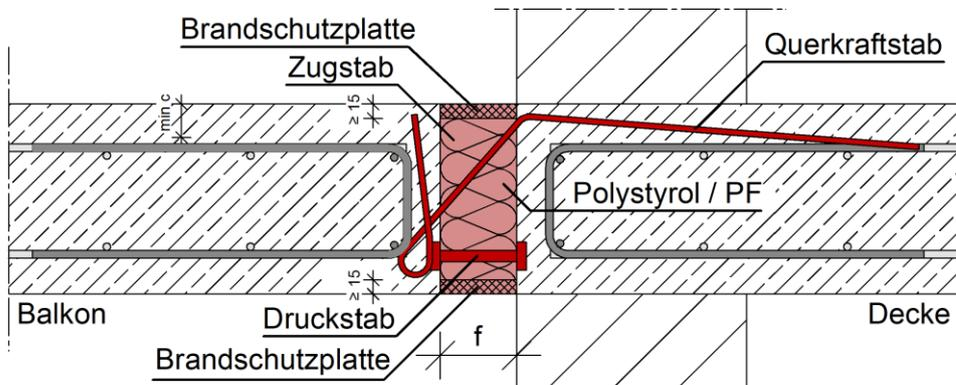
Abbildung C - 3 Egcobox V - Querkraftanschluss – Ausführung mit Brandschutzplatte
