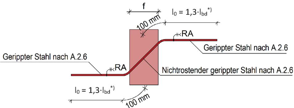
Abbildung A - 37 Querkraftstabvariante 3 – nichtrostender Stahl
