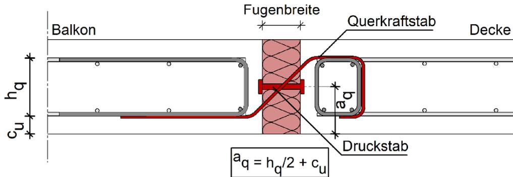
Abbildung A - 10 Egccobox Typ V – Querkraftanschluss – mittiges Drucklager und bauseitigem Randbalken
