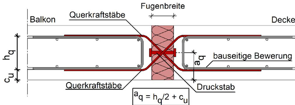
Abbildung A - 8 Egcobox Typ V± – Querkraftanschluss zu Übertragung von positiven und negativen Querkraften und mittigem Drucklager
