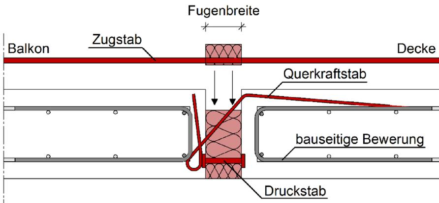
Abbildung A - 2 Egcoflex Typ M – Momenten- und Querkraftanschluss 2-teilig – Querkraftstab mit Schlaufe
