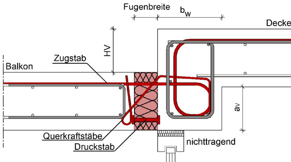
Abbildung A - 14 Egco box Typ HV mit Höhenversatz des getragenen Bauteils nach unten – Querkräftstab mit Schlaufe
