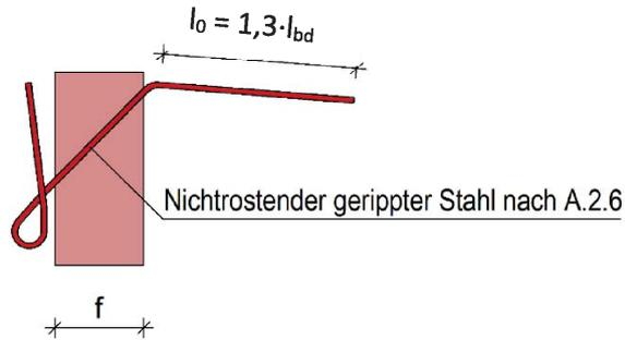
Abbildung A - 35 Querkraftstabvariante 1 – Schleufe nichtrostender Stahl
