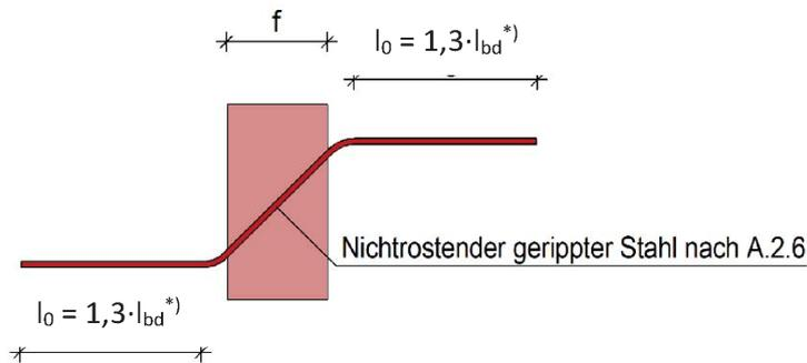
Abbildung A - 38 Querkraftstabvariante 4 – stumpfgeschweißt
