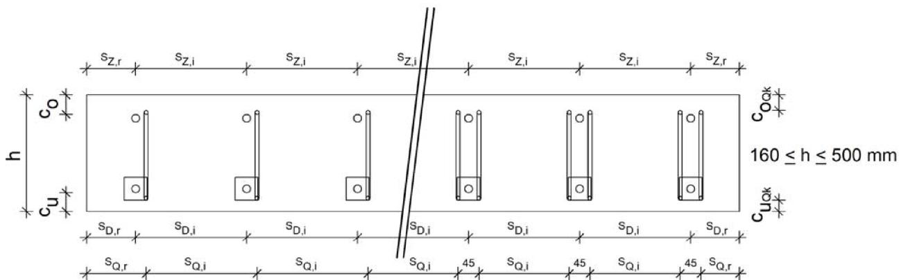
Abbildung A - 27 Geometrische Randbedingungen Darstellung mit einer und zwei Querkraftstabschlaufen je Drucklager
