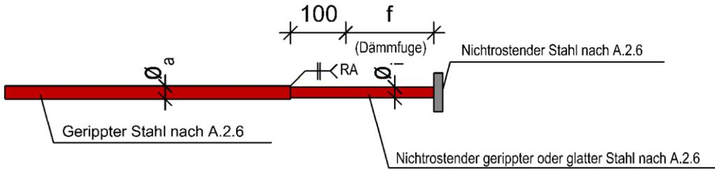
Abbildung A - 33 Druckstabvariante 4 – stumpfgeschweißt mit einseitiger Druckplatte
