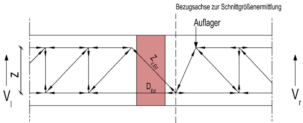
Abbildung D - 5 Egccobox V - Querkraftanschluss – statisches System für abhebende Kräfte
