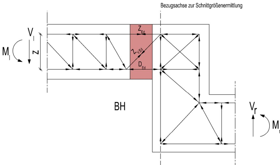
Abbildung D - 7 Egccobox BH - Momenten- und Querkraftanschluss mit Höhenversatz – statisches System
