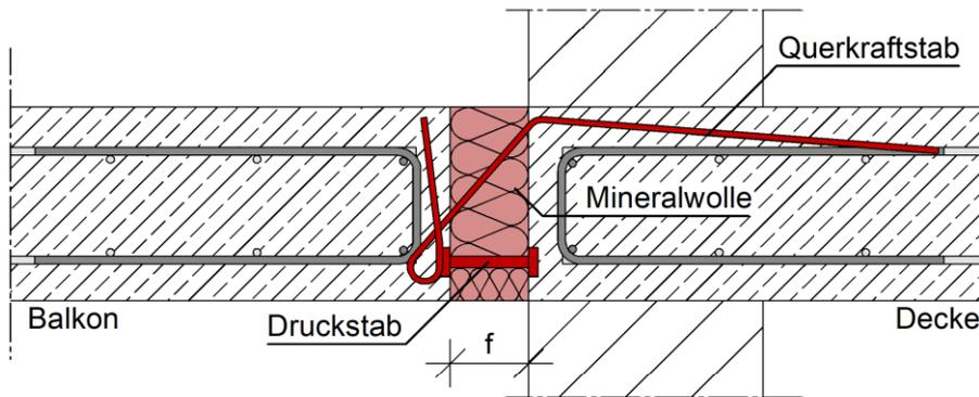
Abbildung C - 6 Egcobox V - Querkraftanschluss – Ausführung mit Mineralwolle
