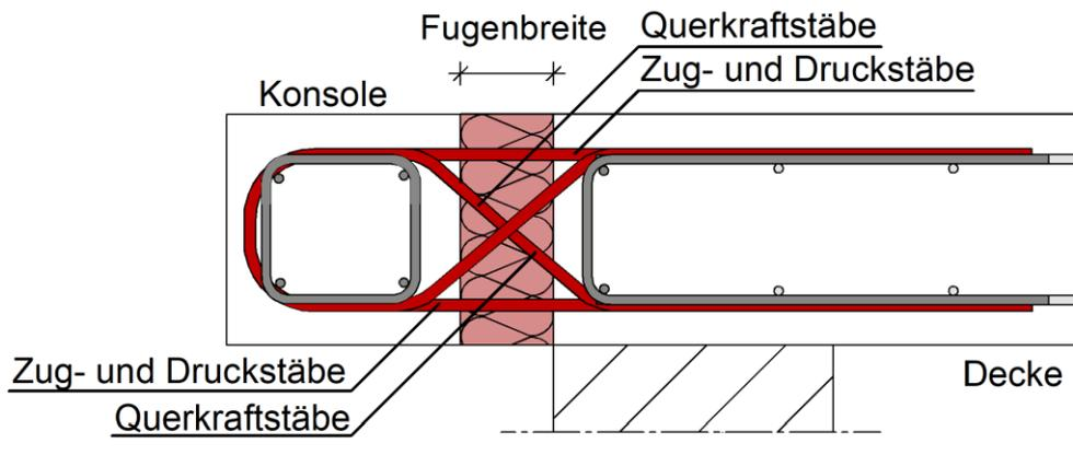
Abbildung A - 23 Egccobox Typ A – Konsole – Momenten-, Querkraft- und Normalkraftanschluss
