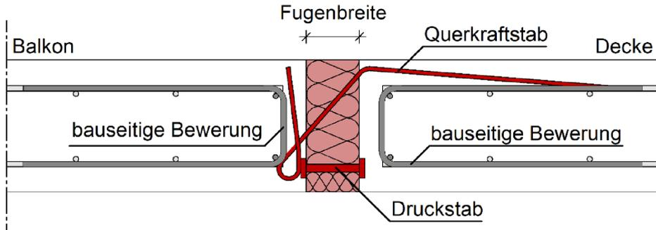
Abbildung A - 4 Egcoibox Typ V – Querkraftanschluss – Querkraftstab mit Schlaufe
