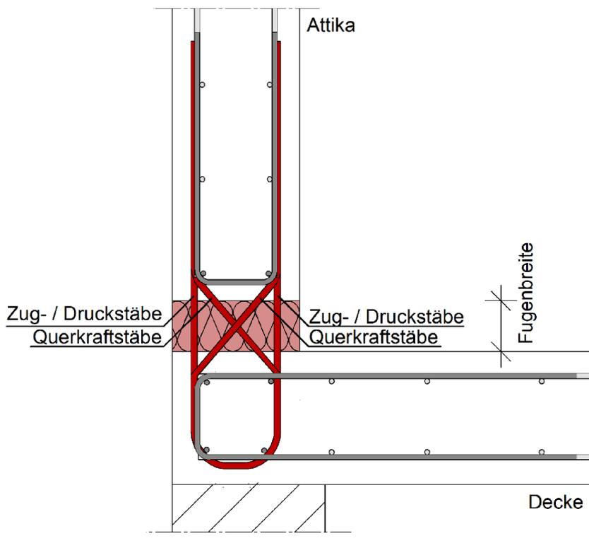
Abbildung A - 21 Egcoflex Typ A – Attika – Momenten-, Querkraft- und Normalkraftanschluss
