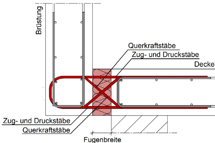
Abbildung A - 22 Egcoflex Typ A – Fassade – Momenten-, Querkraft- und Normalkraftanschluss
