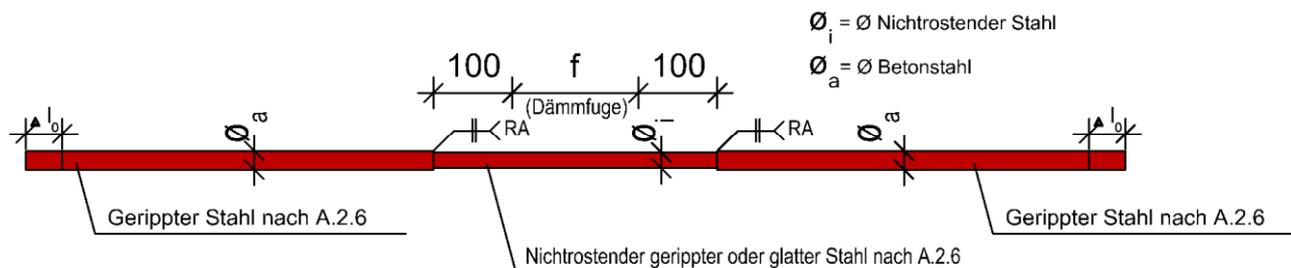
Abbildung A - 29 Zugstabvariante 2 – stumpfgeschweißt
