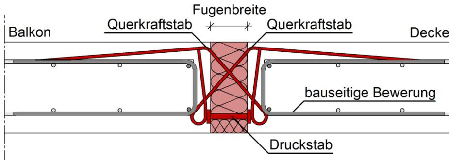
Abbildung A - 7 Egcobox Typ V± – Querkraftanschluss zu Übertragung von positiven und negativen Querkraften – Querkraftstab mit Schlaufe
