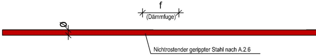
Abbildung A - 30 Druckstabvariante 1 – nichtrostender Stahl
