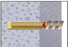
8. Befestigungselement mit leichten Drehbewegungen bis zur festgelegten Setztiefe einführen. Die Ankerstange muss schmutz-, fett-, und ölfrei sein.
