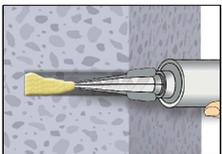
6. Gereinigtes Bohrloch vom Bohrlochgrund her ca. zu 2/3 mit Verbundmörtel befüllen. Langsames Zurückziehen des Statikmischers aus dem Bohrloch verhindert die Bildung von Luftporen. Wird der Bohrlochgrund nicht erreicht, muss eine passende Mischerverlängerung verwendet werden. Die temperaturrelevanten Verarbeitungszeiten (Tabelle B5) sind zu beachten.
