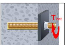
11. Nach vollständiger Aushärtung kann das Anbauteil mit bis zu dem maximalen Drehmoment (Tabelle B1 oder B3) montiert werden. Die Mutter muss mit einem kalibriertem Drehmomentschlüssel festgezogen werden. Optional kann der Ringspalt zwischen Ankerstange und Anbauteil mit Mörtel verfüllt werden. Dafür Unterlegscheibe durch Verfüllscheibe ersetzen und Mischerrückführung auf den Mischer stecken. Der Ringspalt ist verfüllt, wenn Mörtel austritt.
