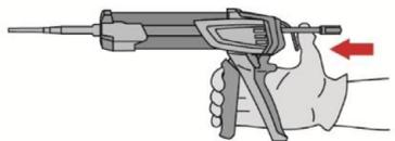
Nach der Mörtelinjektion die Entriegelungstaste am Auspressgerät betätigen, um Mörtelnachlauf zu vermeiden.
