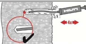
Bohrloch erneut mit der Hilti Handausblaspumpe vom Bohrlochgrund mindestens 4-mal ausblasen, bis die rückströmende Luft staubfrei ist.
