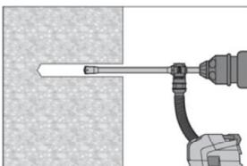
Die Bohrlochherstellung bis zur erforderlichen Setztiefe erfolgt dreh Schlagend mit einem Hilti Hohlbohrer TE-CD oder TE-YD in Kombination mit einem Hilti Staubsauger VC 20/40 (-Y) (Saugvolumen  $\geq 57$  l/s) bei dem die automatische Filterreinigung aktiviert ist. Dieses Bohrsystem beseitigt bei Anwendung gemäß der Gebrauchsanweisung des Hohlbohrers das Bohrmehl und reinigt das Bohrloch während des Bohrvorgangs.
