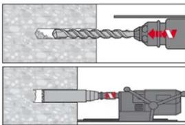
Die Bohrlochherstellung bis zur erforderlichen Setztiefe erfolgt dreh Schlagend mithilfe eines Bohrhammers, mithilfe eines Pressluftbohrers oder mithilfe eines Diamantkernbohrers unter Verwendung des passenden Bohrerdurchmessers.
