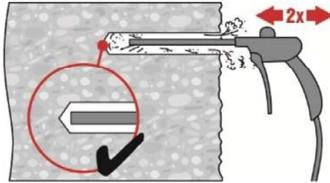
Bohrloch 2-mal vom Bohrlochgrund über die gesamte Länge mit ölfreier Druckluft (min. 6 bar bei 6 m<sup>3</sup>/h; falls notwendig mit Verlängerung) ausblasen, bis die rückströmende Luft staubfrei ist.
