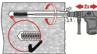
Die Rundbürste HIT-RB auf Verlängerung(en) HIT-RBS aufschrauben, so dass die Gesamtlänge ausreichend ist um das Bohrlochende zu erreichen. Das andere Ende der Verlängerung im Bohrfutter TE-C/TE-Y befestigen.
