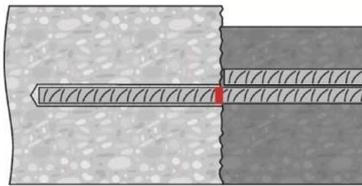
Eine Belastung des Bewehrungsanschlusses darf erst nach Ablauf der Aushärtezeit  $t_{cure}$  erfolgen (siehe Tabelle B3).
