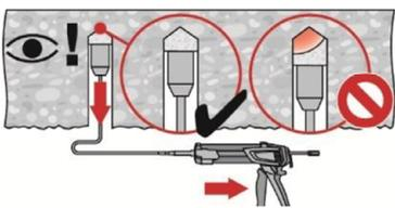
Das Injizieren des Mörtels bei Überkopfanwendung ist nur mit Hilfe von Stauzapfen und Verlängerungen möglich.
