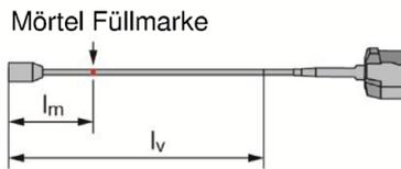
Mörtel Füllmarke l<sub>m</sub> und Setztiefe l<sub>v</sub> mit Klebeband oder Filzstift markieren.
