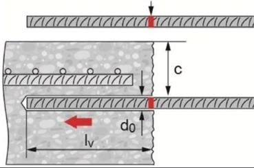
Vor dem Gebrauch sicherstellen, dass der Betonstahl trocken und frei von Öl oder anderen Verunreinigungen ist.
