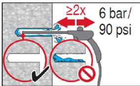
Bohrloch 2-mal vom Bohrlochgrund über die gesamte Länge mit ölfreier Druckluft (min. 6 bar bei  $6\text{m}^3/\text{h}$ ; falls notwendig mit Verlängerung) ausblasen, bis die rückströmende Luft staubfrei und das Bohrloch trocken ist.
