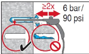
Bohrloch erneut vom Bohrlochgrund über die gesamte Länge 2-mal mit Druckluft ausblasen, bis die rückströmende Luft staubfrei und das Bohrloch trocken ist.
