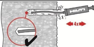
Für Bohrdurchmesser  $d_0 \leq 20$  mm und Bohrtiefen  $h_{ef} \leq 10 \cdot d$  kann die Hilti Handausblaspumpe verwendet werden.
