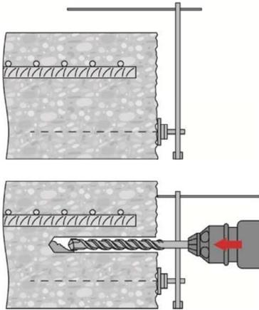
Sicherstellen, dass das Bohrloch parallel zur bestehenden Bewehrung ist.
