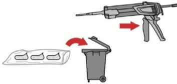
Das Öffnen der Hartkartusche erfolgt automatisch bei Auspressbeginn. Der am Anfang aus dem Mischer austretende Mörtelvorlauf darf nicht für Befestigungen verwendet werden. Die Menge des Mörtelvorlaufes ist 3 volle Hübe.
