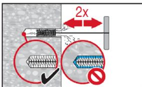
2-mal mit Stahlbürste in passender Größe (Bürste  $\varnothing \geq$  Bohrloch  $\varnothing$ , siehe Tabelle B4) bürsten. Stahlbürste Hilti HIT-RB mit einer Drehbewegung in das Bohrloch bis zum Bohrlochgrund einführen und wieder herausziehen (falls notwendig mit Verlängerung).
