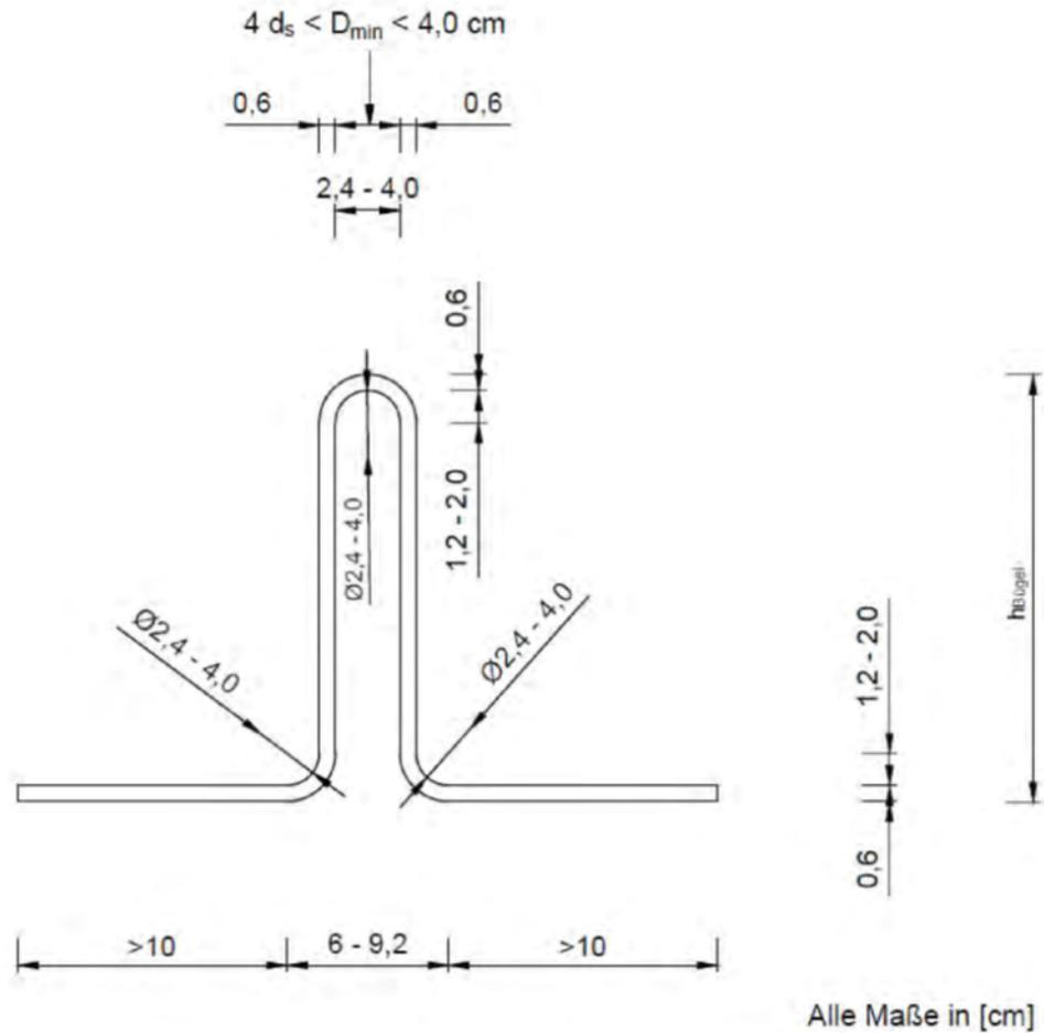
$h_{Bügel}$  in Abhängigkeit von der Plattenhöhe  $h$  und der Betonüberdeckung des Blechs unten ( $c_{unten}$ ) und der obersten Lage der Biegezugbewehrung oben ( $c_{oben}$ ). Für  $c_{unten}$  und  $c_{oben}$  siehe auch Anhang B2, B3.
