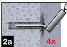
2a. Das Bohrloch vom Bohrlochgrund her 4x vollständig oder Handpumpe (Anhang B 7) ausblasen.
