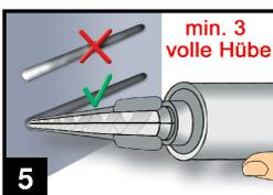
5. Mörtelvorlauf ist nicht zur Befestigung des Bewehrungsstabs geeignet. Daher Vorlauf solange verwerfen, bis sich eine gleichmäßig graue Mischfarbe eingestellt hat, jedoch min. 3 volle Hübe.
