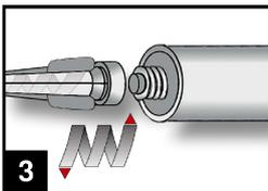
3. Den mitgelieferten Statikmischer fest auf die Kartusche aufschrauben und Kartusche in eine geeignete Auspresspistole einlegen. Bei jeder Arbeitsunterbrechung länger als die empfohlene Verarbeitungszeit (Tabelle B3) und bei jeder neuen Kartusche ist der Statikmischer auszutauschen.
