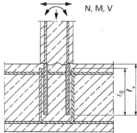
**Bild A3:** Endverankerung von Platten oder Balken
