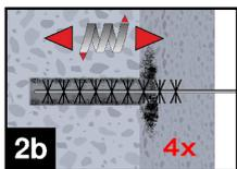
2b. Der Bürstendurchmesser ist zu überprüfen (Tabelle B5). Bohrloch mit geeigneter Bürste  $> d_{b,min}$  (Tabelle B5) mindestens 4x mittels Drehbewegung ausbürsten. Bei tiefen Bohrlöchern ist eine geeignete Bürstenverlängerung zu benutzen.
