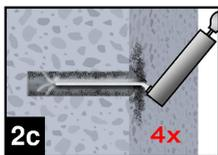
2c. Abschließend das Bohrloch erneut vom Bohrlochgrund her 4x vollständig oder Handpumpe (Anhang B 7) ausblasen.
