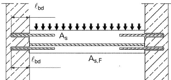
**Bild A4:** Bewehrungsanschlüsse überwiegend auf Druck beanspruchter Bauteile
