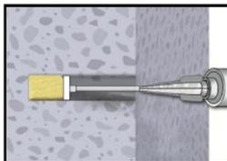
Für die Horizontal- oder Überkopfmontage sowie bei Bohrlöchern tiefer als 240mm sind zwingend Verfüllstutzen zu verwenden.
