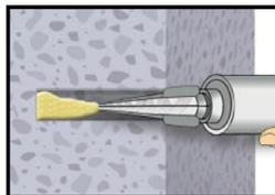
4. Gereinigtes Bohrloch vom Bohrlochgrund her mit Verbundmörtel solange befüllen, bis die Markierung auf der Mischerverlängerung (s.unten) am Bohrlochansatz erscheint.
