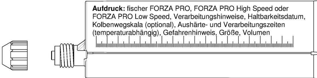
**Injektionskartusche (Coaxialkartusche) mit Verschlusskappe; Größen: 100 ml, 150 ml, 300 ml, 380 ml, 400 ml, 410 ml**
