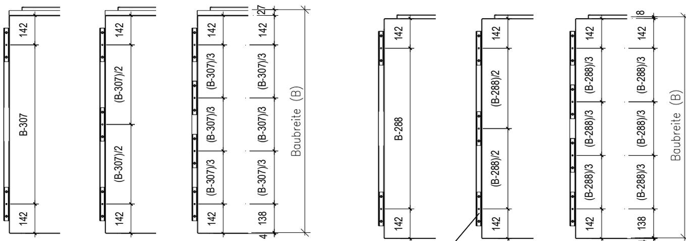
Lastverteiler werden werkseitig auf den Sandwichelementen befestigt
