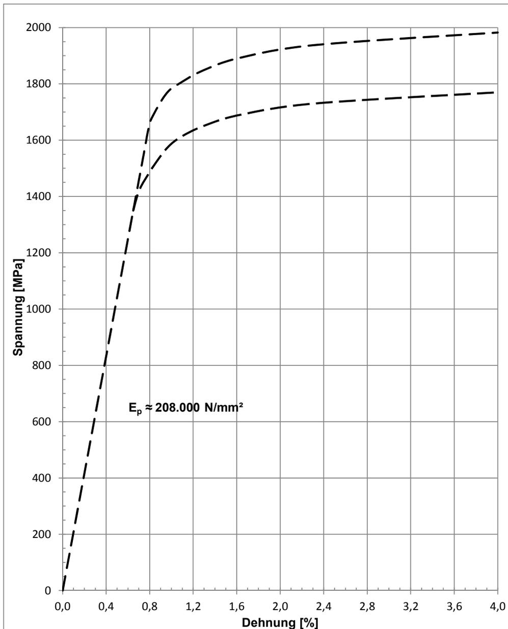
Die Linien geben eine Orientierung für den prinzipiellen Spannungs-Dehnungs-Verlauf bei Annahme des Rechenwerts des E-Moduls ( $E_p$ ) von 208.000 N/mm<sup>2</sup>.
