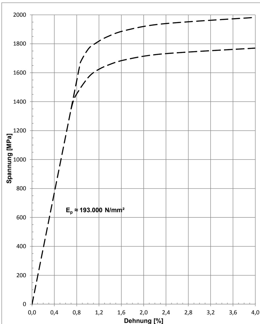
Die Linien geben eine Orientierung für den prinzipiellen Spannungs-Dehnungs-Verlauf bei Annahme des Rechenwertes des E-Moduls ( $E_p$ ) von 193.000 N/mm<sup>2</sup>.
