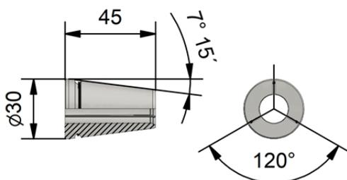
Keilsätze für die Verankerungen der 150mm<sup>2</sup> Litze (ø 0,62") tragen an der Oberseite den Aufdruck 0.62.
