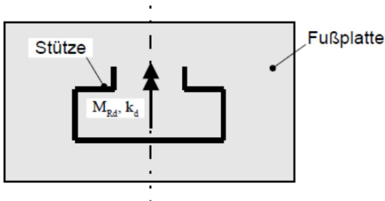
**Abbildung 1:** Orientierung der Rotationssteifigkeiten  $k_d$  und Grenzbiegemomente  $M_{Rd}$
