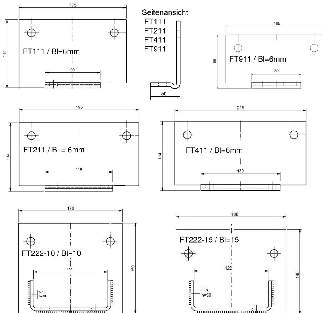
Der Lochdurchmesser in der Fußplatte zur Bodenbefestigung beträgt  $\varnothing=13\text{mm}$ .
