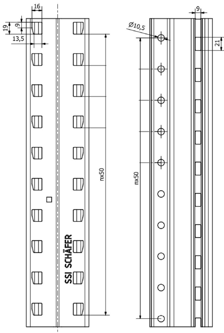
Abb.: Systemlochung der Stützenprofile.
