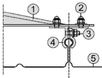
Kalzip-Befestigungsklemme FA2 für Anschlagseinrichtungen
