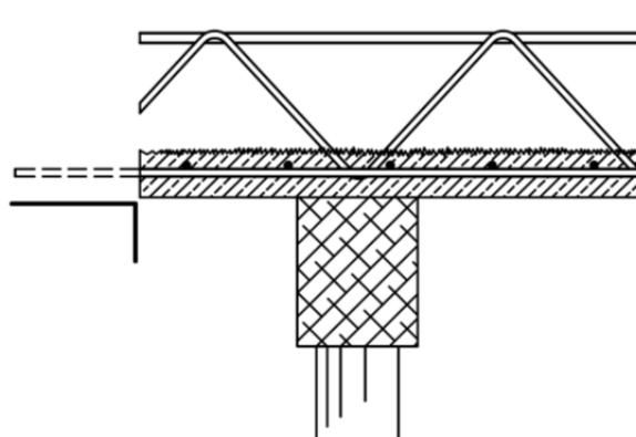
Intersig-Gitterträger für Fertigplatten mit statisch mitwirkender Ortbetonschicht
