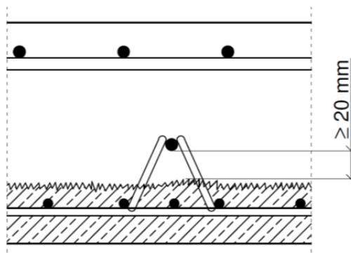
**Bild 7: Gitterträger als Verbund- und Querkraftbewehrung (mäßige Beanspruchung)**
