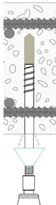
Würth Verbundankerschraube RELAST für die Durchstanzverstärkung
