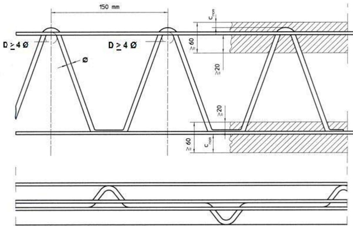
Gitterträger KT 800, KT 900 oder KTE und Anwendungsbestimmungen für wandartige Bauwerksstrukturen bei Verwendung dieser Bewehrung
