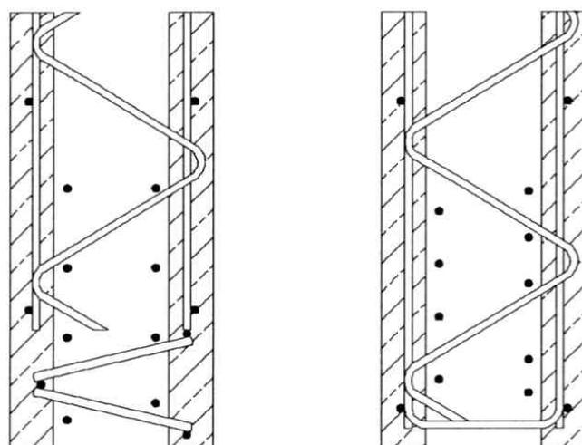
Randsicherung durch Gitterträger
