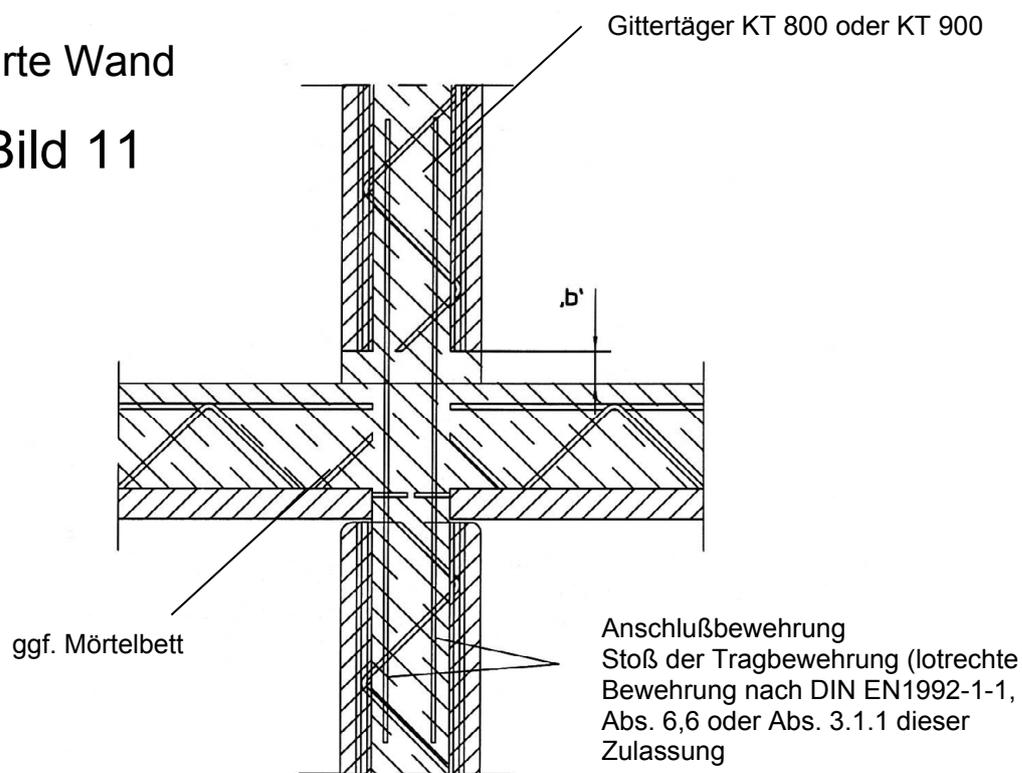
Gitterträger KT 800, KT 900 oder KTE und Anwendungsbestimmungen für wandartige Bauwerksstrukturen bei Verwendung dieser Bewehrung
