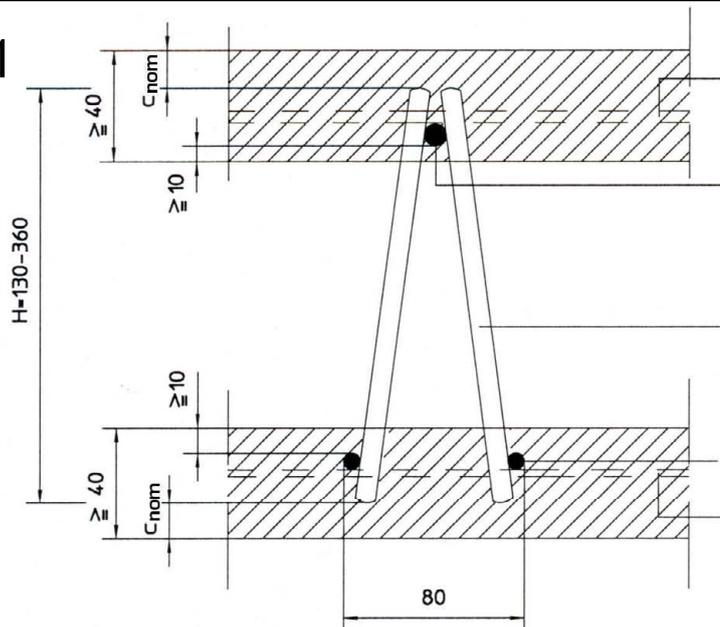
Riegelstab  $\geq 5$  mm
