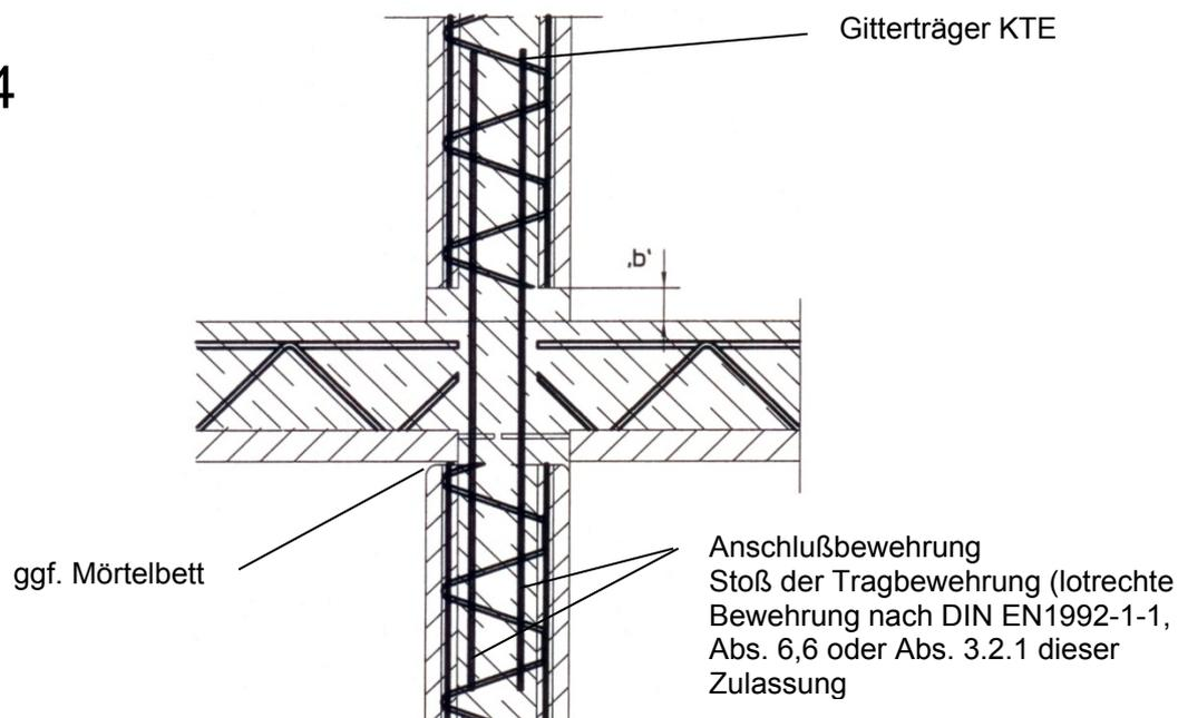
Gitterträger KT 800, KT 900 oder KTE und Anwendungsbestimmungen für wandartige Bauwerksstrukturen bei Verwendung dieser Bewehrung
