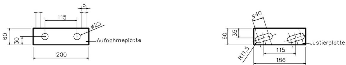
Abb.16 Detail Aufnahmeplatte und Justierplatte
