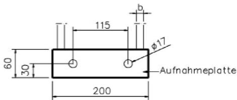
Abb.8 Detail Aufnahmeplatte und Justierplatte
