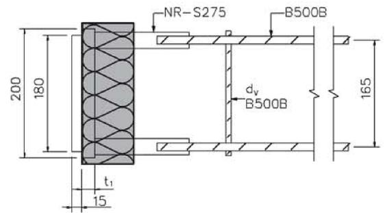
Abb.19a- 19d Querkraftelemente
