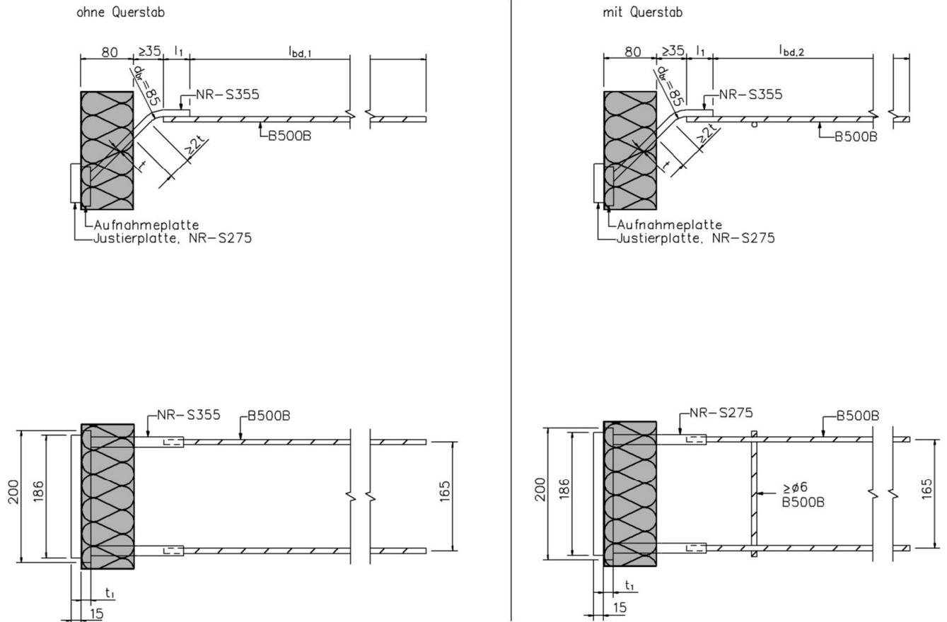
Abb.15a– 15d Querkraftelemente
