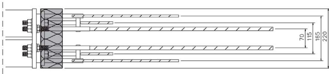
Abb.6 Grundriss Isopro Typ SBM14 Q8 und SBM14 Q10
