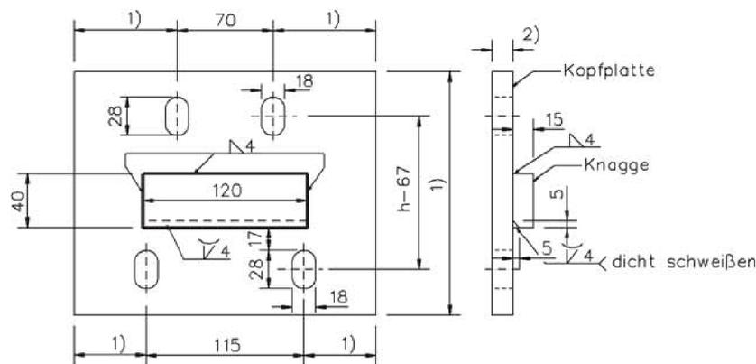
Abb. 31 bauseitige Kopfplatte für die Elemente SBM14 Q8 und SBM14 Q10
