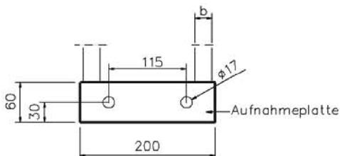
Abb.20 Detail Aufnahmeplatte und Justierplatte
