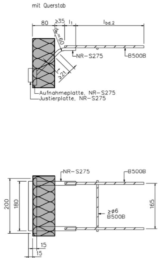
Abb.11a- 11d Querkraftelemente
