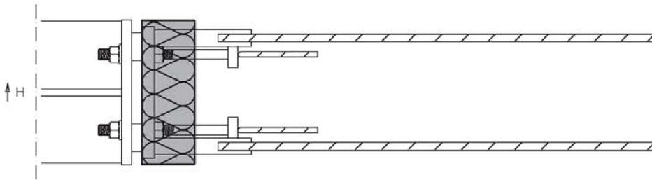
Abb.28 Grundriss Isopro Typ SBQ8, SBQ10 und SBQ12
