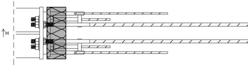
Abb. 22 Grundriss Isopro Typ SBM14 Q8 und SBM14 Q10
