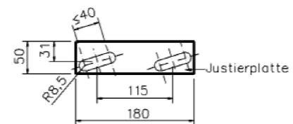
Abb.12 Detail Aufnahmeplatte und Justierplatte
