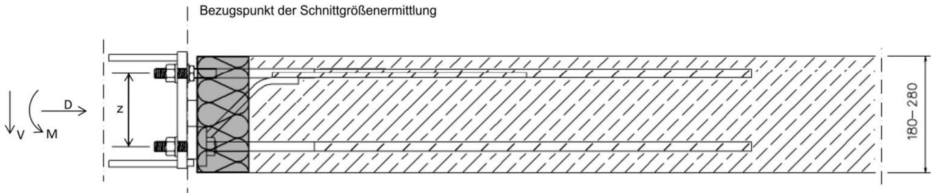
Abb. 23 Seitenansicht Isopro Typ SBM14 QQ
