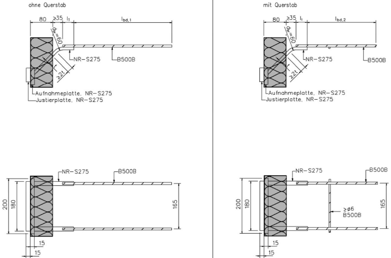
Abb.7a- 7d Querkraftelemente
