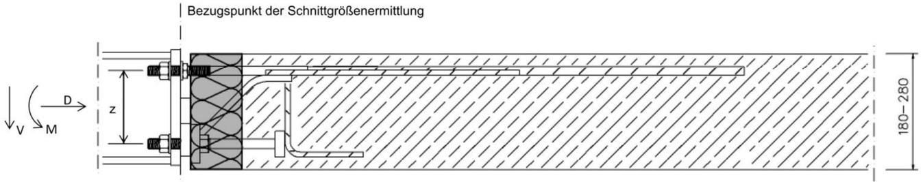
Abb. 21 Seitenansicht Isopro Typ SBM14 Q8 und SBM14 Q10
