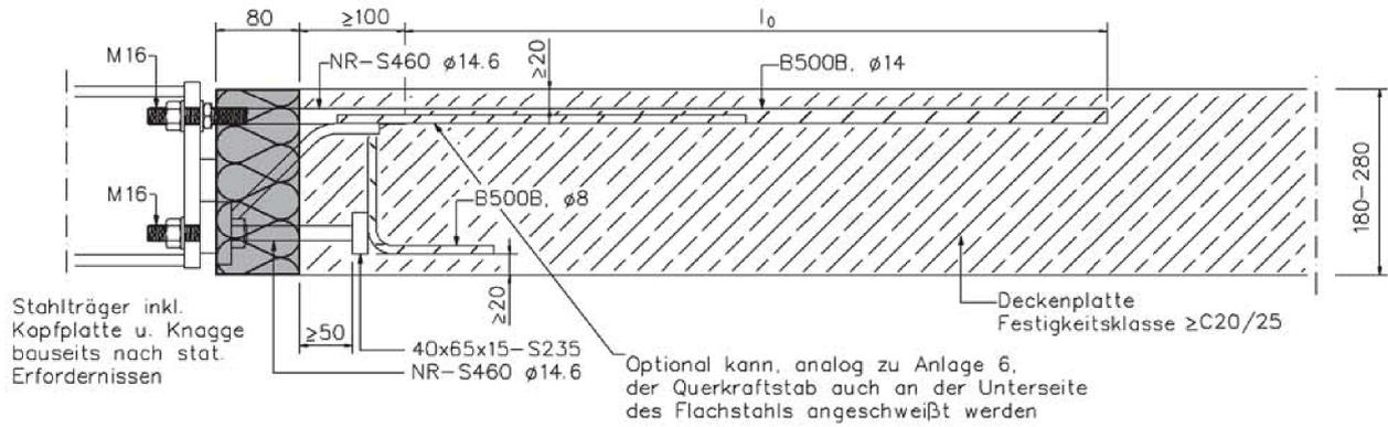
Abb.5 Seitenansicht Isopro Typ SBM 14 Q8 und Q10
