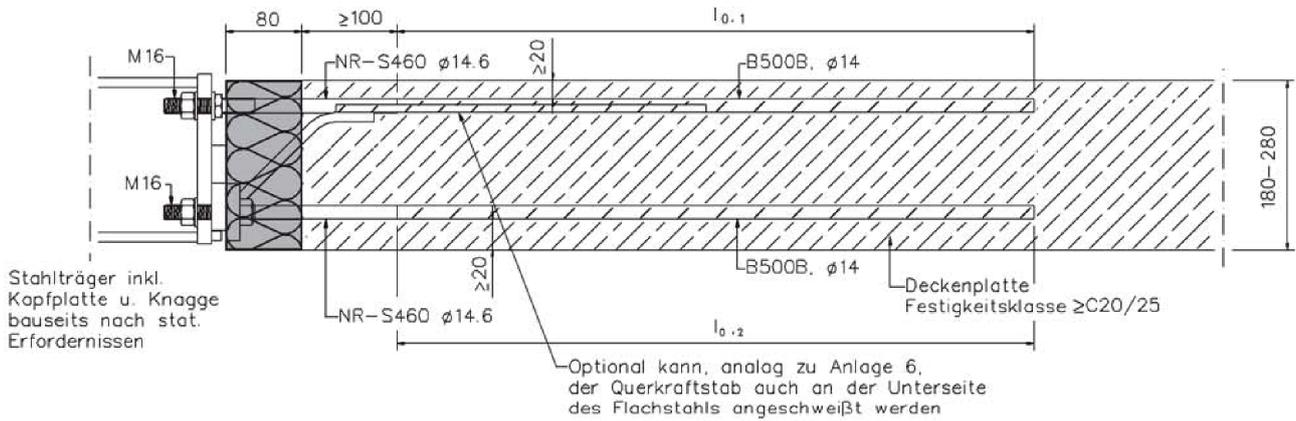
Abb.9 Seitenansicht Isopro Typ SBM 14 QQ
