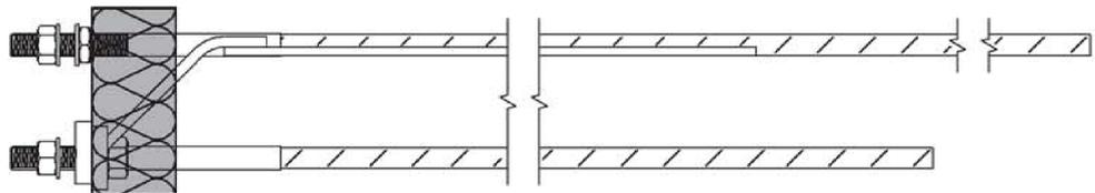
Abb.3 Isopro Typ SBM20 Q10 und SBM20 Q12
