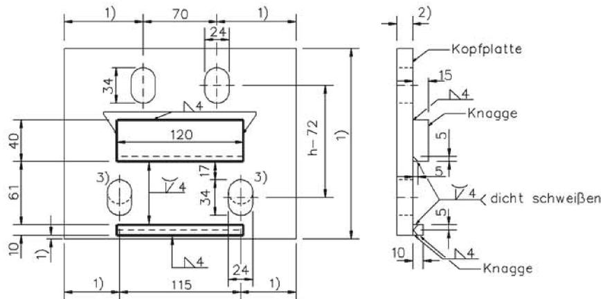
Abb. 35 bauseitige Kopfplatte für das Element SBM20 Q10 und SBM20 Q12
