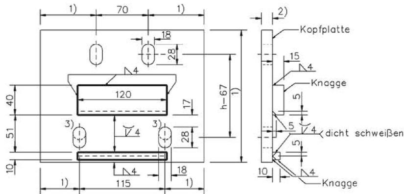
Abb. 33 bauseitige Kopfplatte für die Elemente SBM14 QQ
