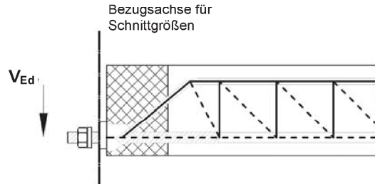
Bild 12: Fachwerkmodell HIT-HP/SP SZV mit Stahlfachwerk
