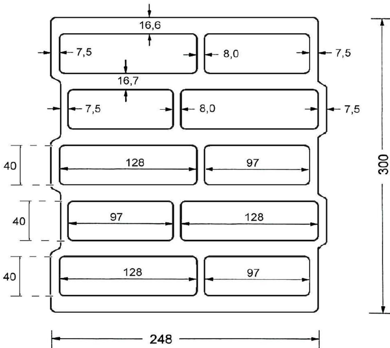
POROTON-DRYFIX Mauerwerk aus POROTON-Planhochlochziegeln-T8 MW DRYFIX mit integrierter Wärmedämmung und POROTON DRYFIX Planziegel-Kleber
