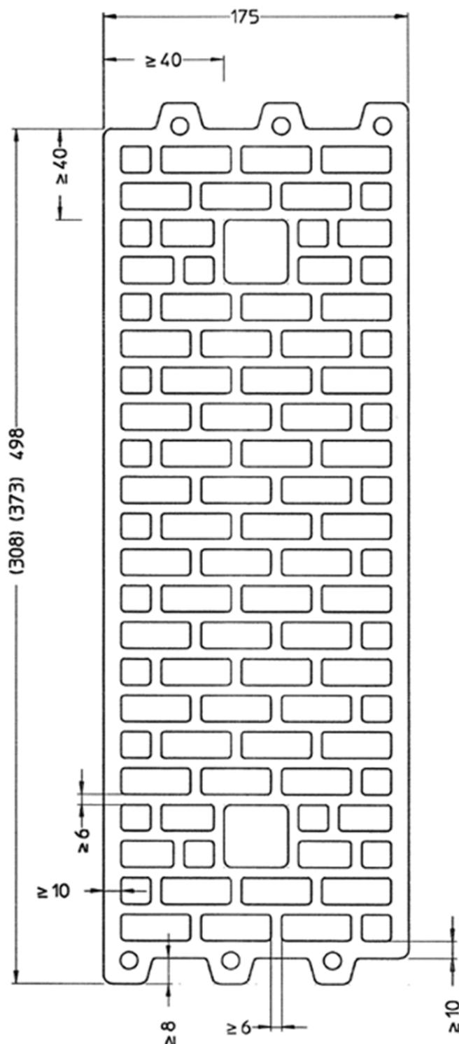
Vorgefertigte Mauertafeln aus Mauerwerk im Klebeverfahren
