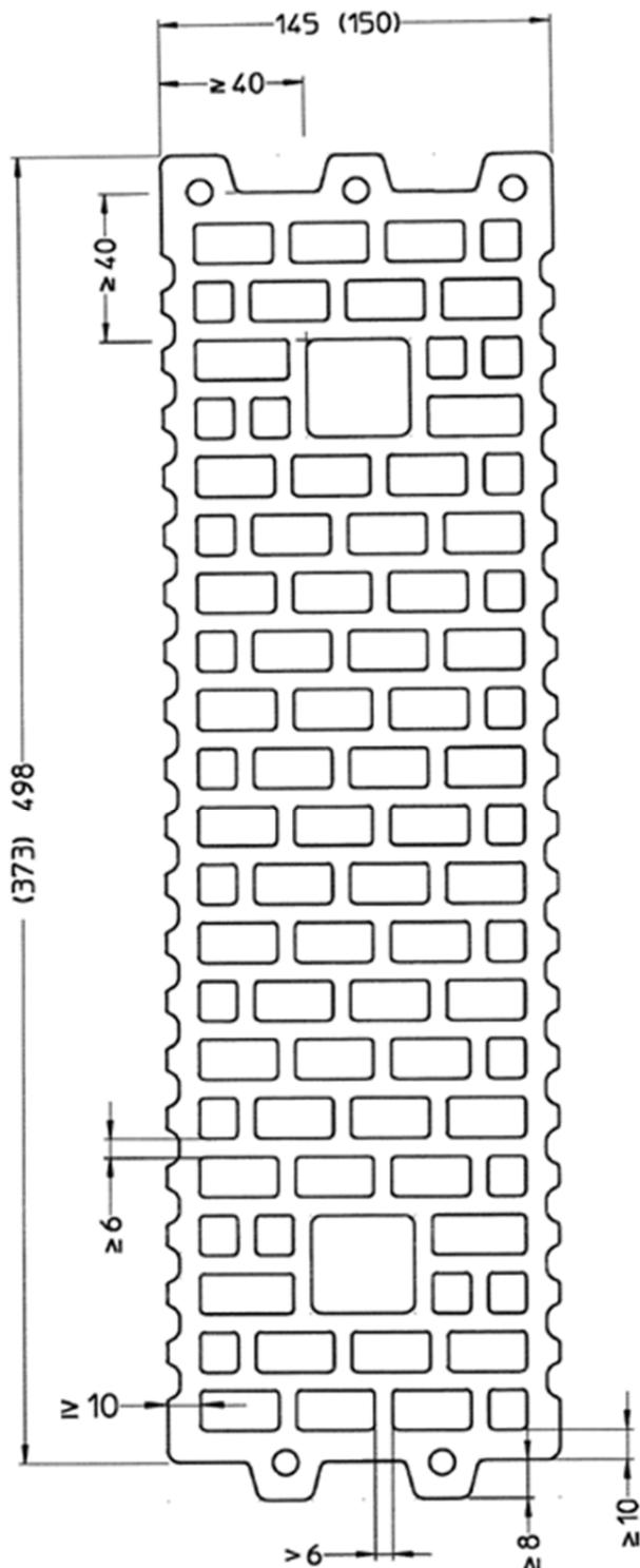
Vorgefertigte Mauertafeln aus Mauerwerk im Klebeverfahren
