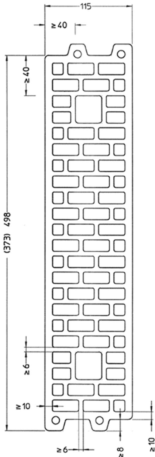
Vorgefertigte Mauertafeln aus Mauerwerk im Klebeverfahren
