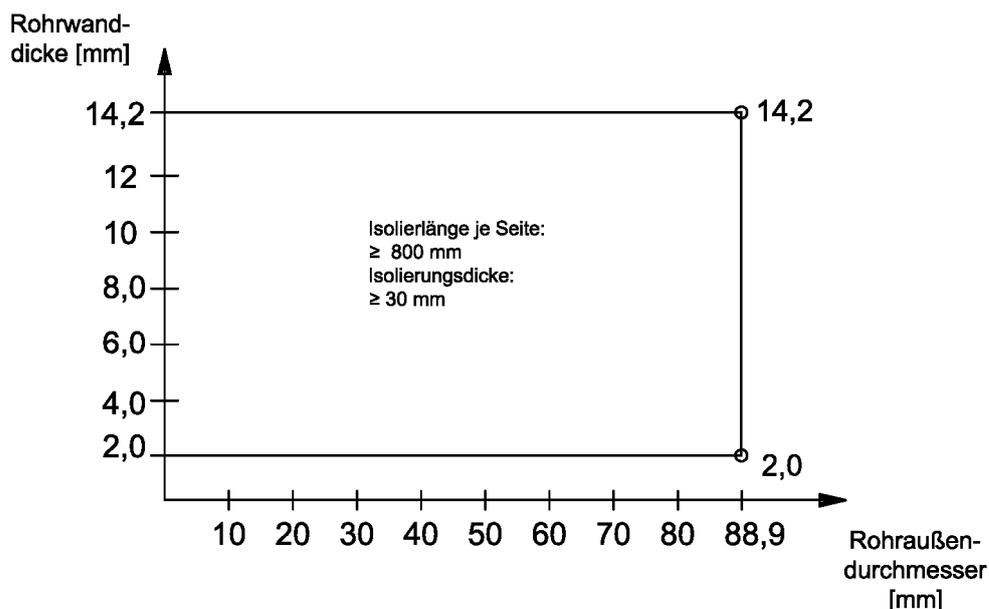
Feuerwiderstandsfähige Abschottung für elektrische Leitungen und/oder Rohrleitungen
