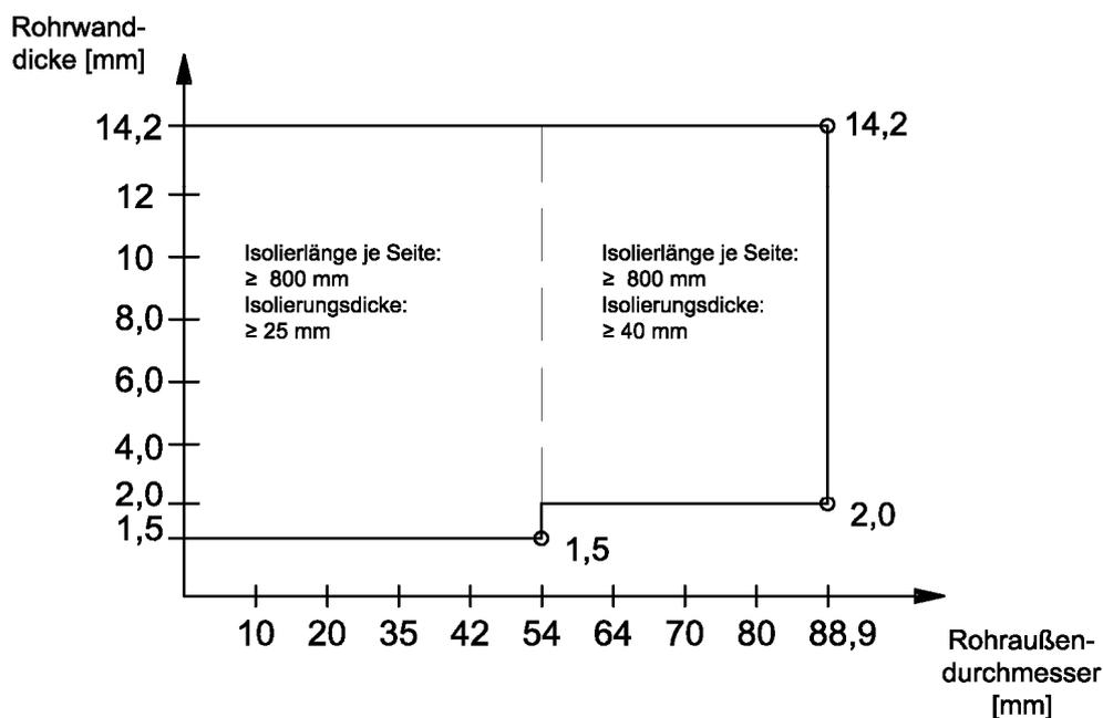
Feuerwiderstandsfähige Abschottung für elektrische Leitungen und/oder Rohrleitungen
