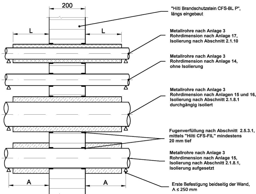
Metallrohre nach Anlage 3 Rohrdimension nach Anlage 17, FEF-Isolierung nach Abschnitt 2.1.10
