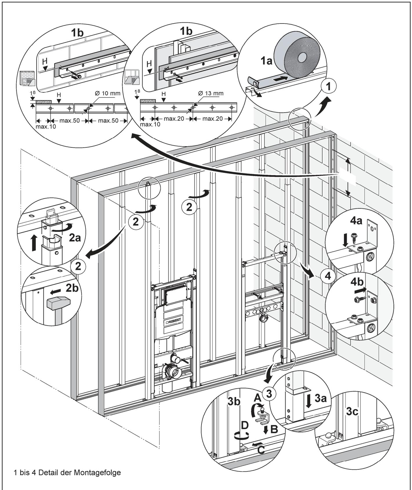
Feuerwiderstandsfähiges Installationsbauteil „Geberit Quattro 90“
