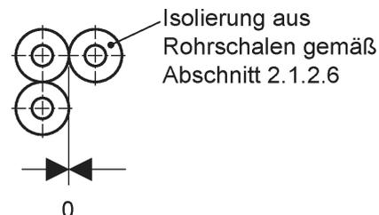
Bei der Anordnung der Rohrleitungen und Lüftungsleitungen dürfen keine Zwickel (Hohlräume) entstehen.
