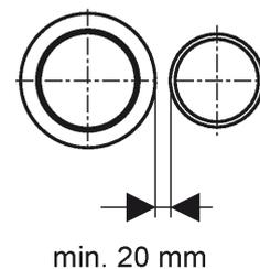
Feuerwiderstandsfähiges Installationsbauteil „Geberit Quattro 90“
