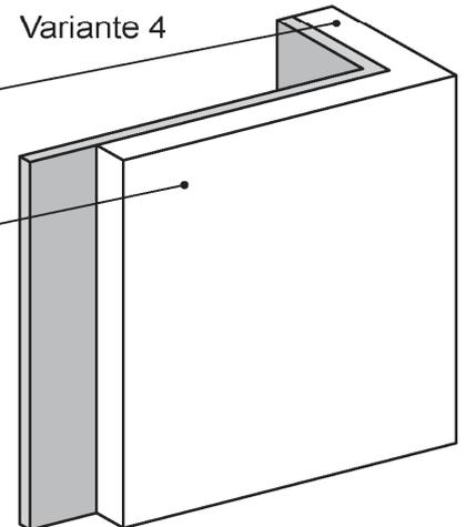
■ Grau hinterlegte Bereiche: Massivbauteile oder leichte Trennwände gemäß Abschnitt 2.3.2.2, max. 3 Seiten
