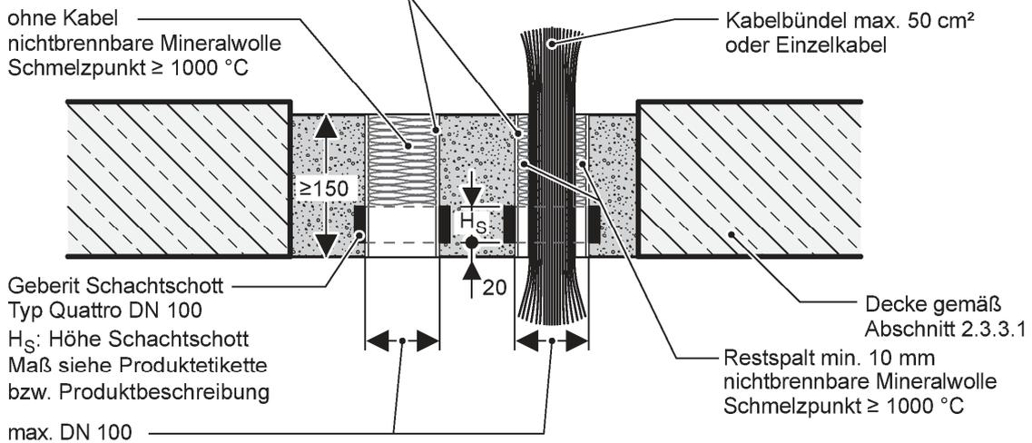
Feuerwiderstandsfähiges Installationsbauteil „Geberit Quattro 90°“
