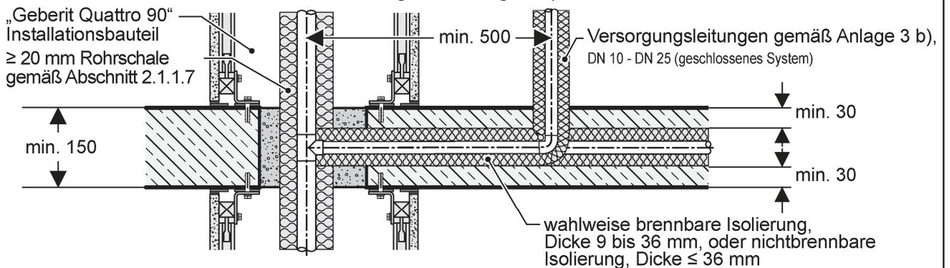
Feuerwiderstandsfähiges Installationsbauteil „Geberit Quattro 90“
