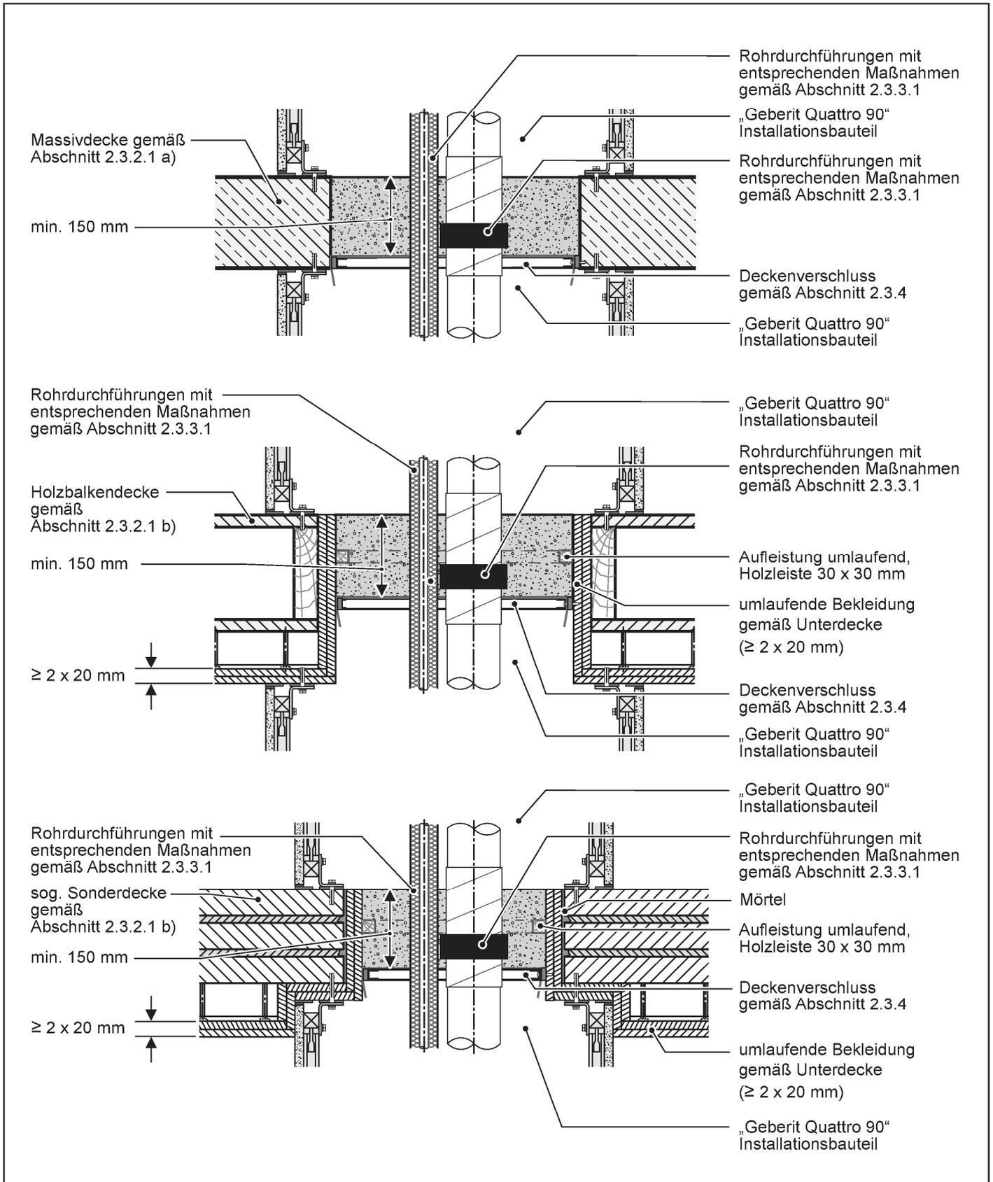
Feuerwiderstandsfähiges Installationsbauteil „Geberit Quattro 90“
