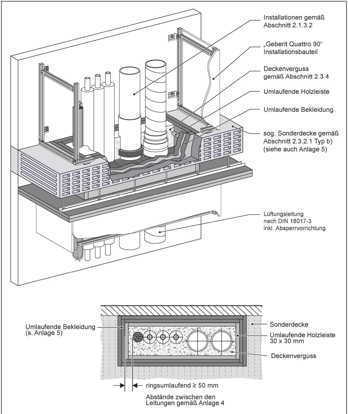
Feuerwiderstandsfähiges Installationsbauteil „Geberit Quattro 90“
