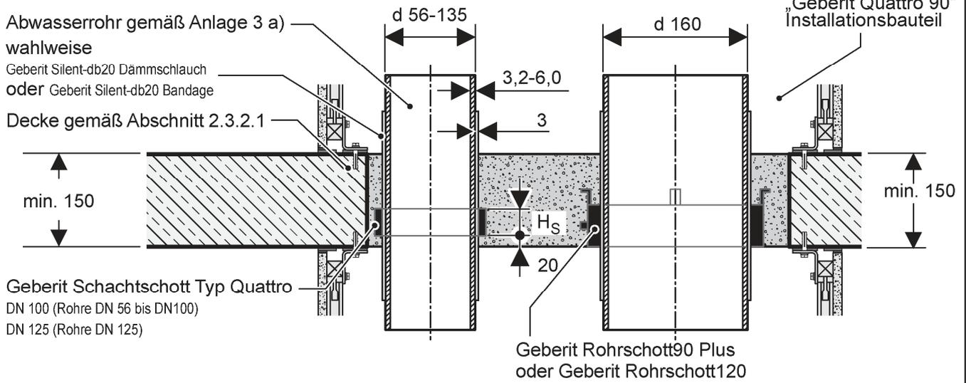
**Schmutz- und Regenwasserleitungen, Leitungsvarianten bei Deckendurchführungen**
