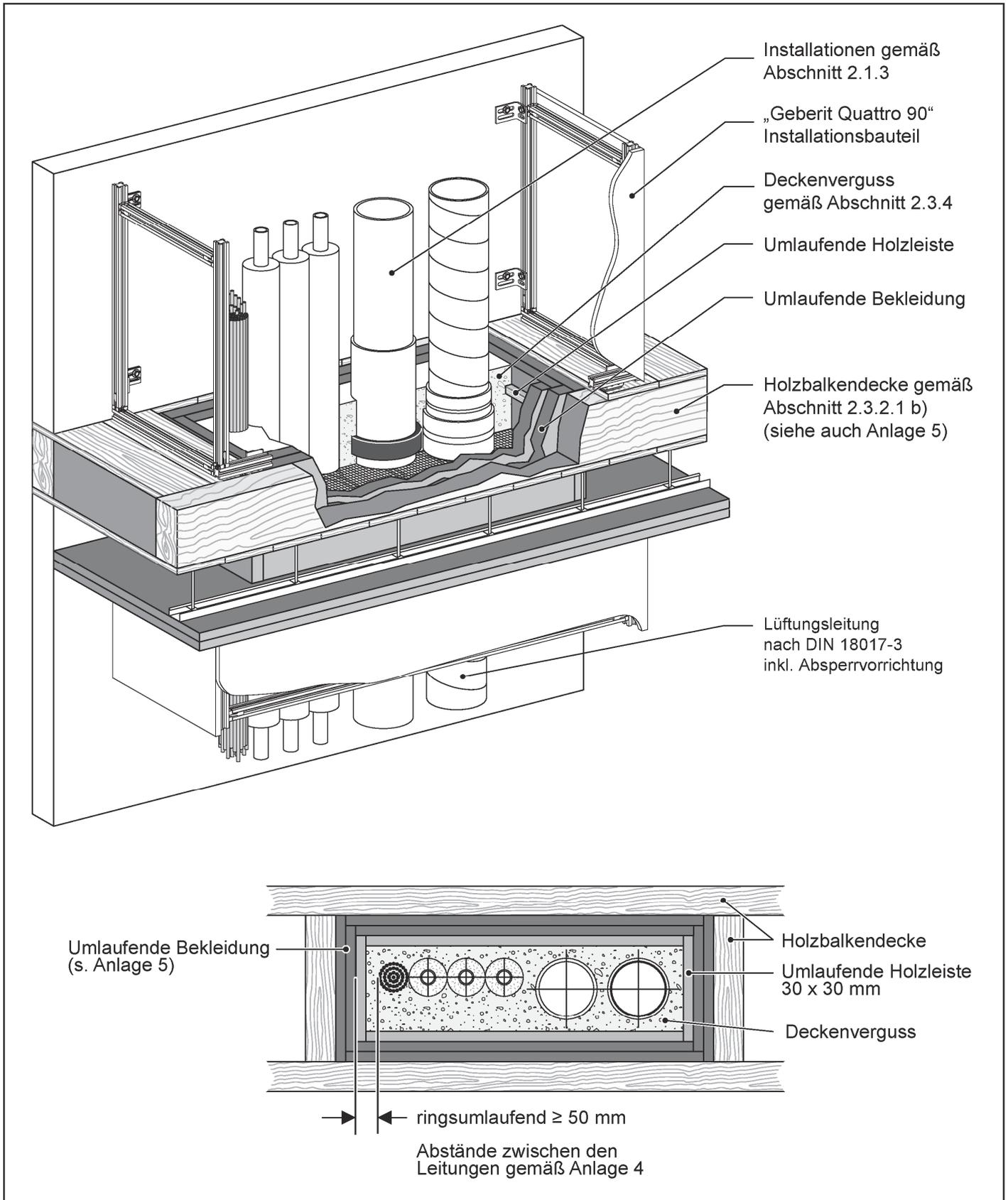
Feuerwiderstandsfähiges Installationsbauteil „Geberit Quattro 90“
