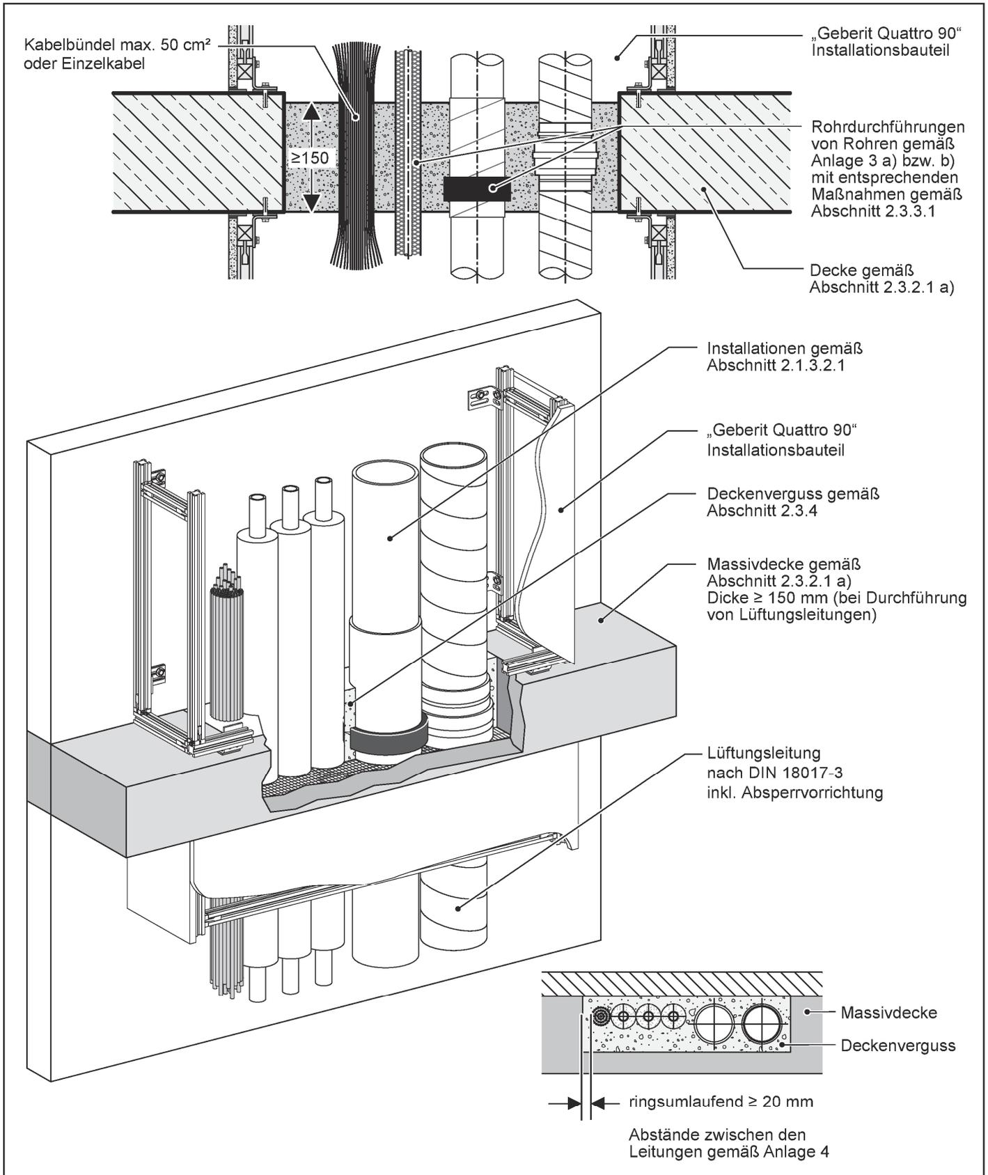
Feuerwiderstandsfähiges Installationsbauteil „Geberit Quattro 90“
