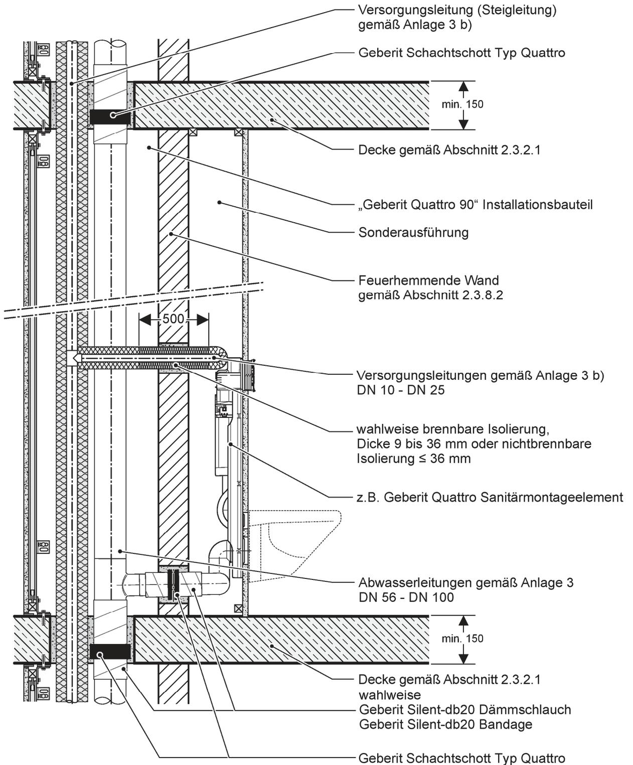
Feuerwiderstandsfähiges Installationsbauteil „Geberit Quattro 90°“
