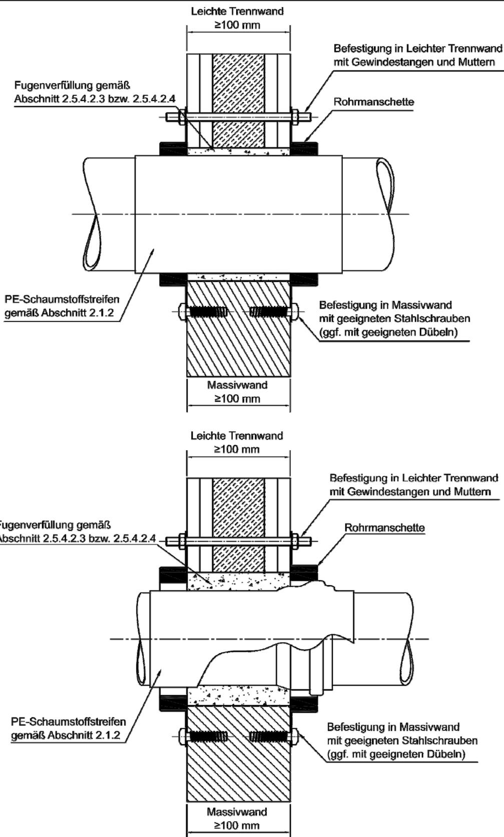
Feuerwiderstandsfähige Abschottung für Rohrleitungen aus Kunststoff "Curaflam System XSPPro" bzw. "System DBM"
