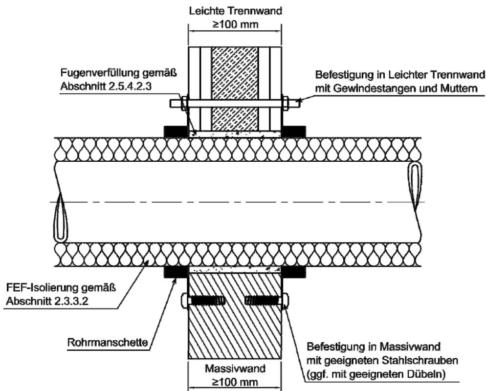
Feuerwiderstandsfähige Abschottung für Rohrleitungen aus Kunststoff "Curaflam System XSPPro" bzw. "System DBM"
