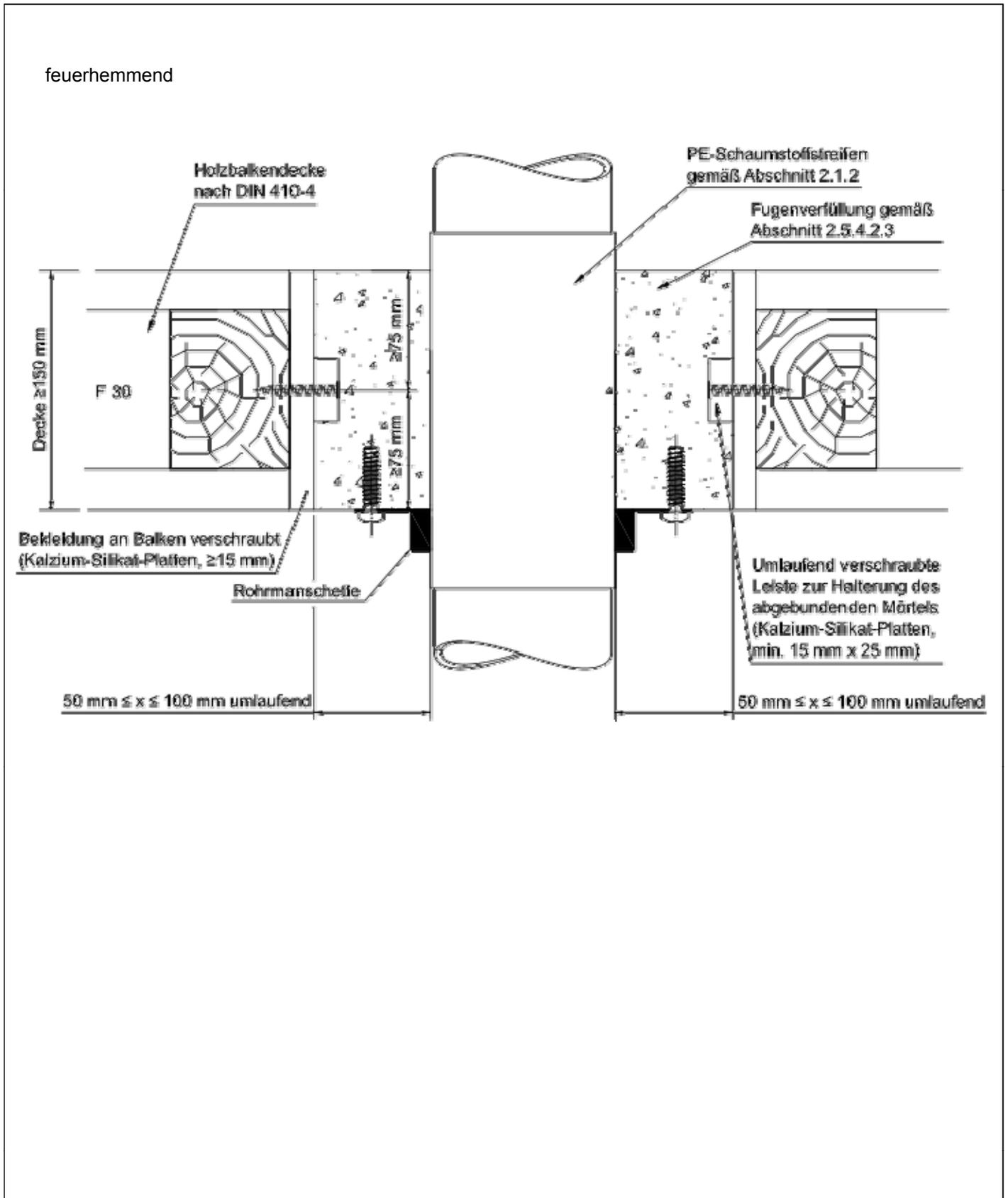
Feuerwiderstandsfähige Abschottung für Rohrleitungen aus Kunststoff "Curaflam System XSP" bzw. "System DBM"
