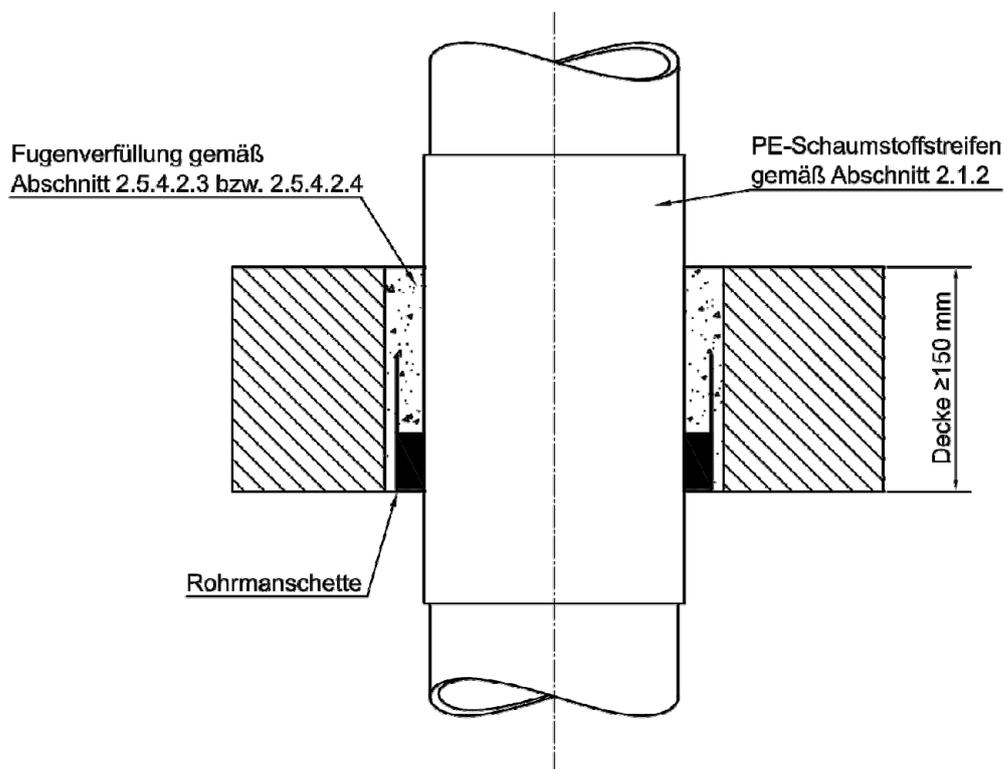
Feuerwiderstandsfähige Abschottung für Rohrleitungen aus Kunststoff "Curaflam System XSP" bzw. "System DBM"
