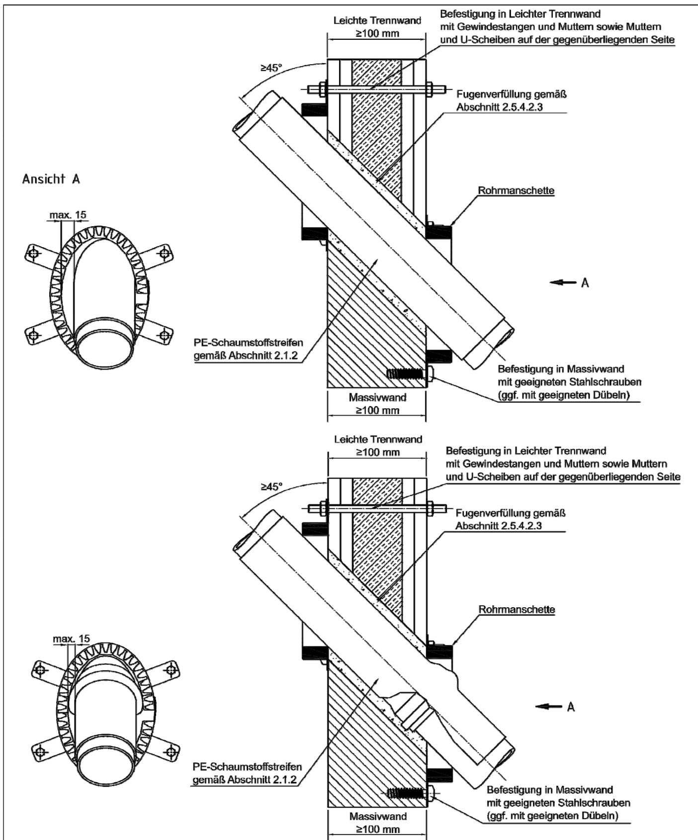
Feuerwiderstandsfähige Abschottung für Rohrleitungen aus Kunststoff "Curaflam System XSPPro" bzw. "System DBM"
