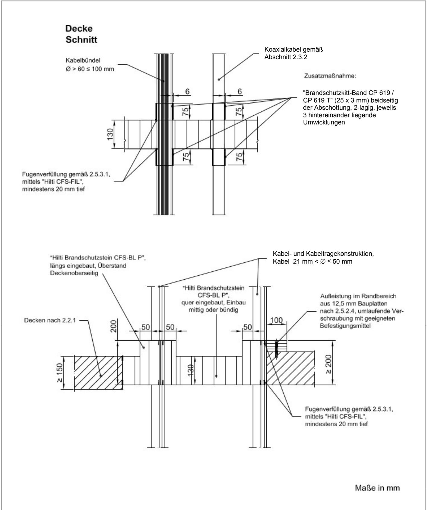
Feuerwiderstandsfähige Abschottung für elektrische Leitungen und Rohrleitungen aus Metall "Hilti Brandschutz-System CFS-BL P-Q"
