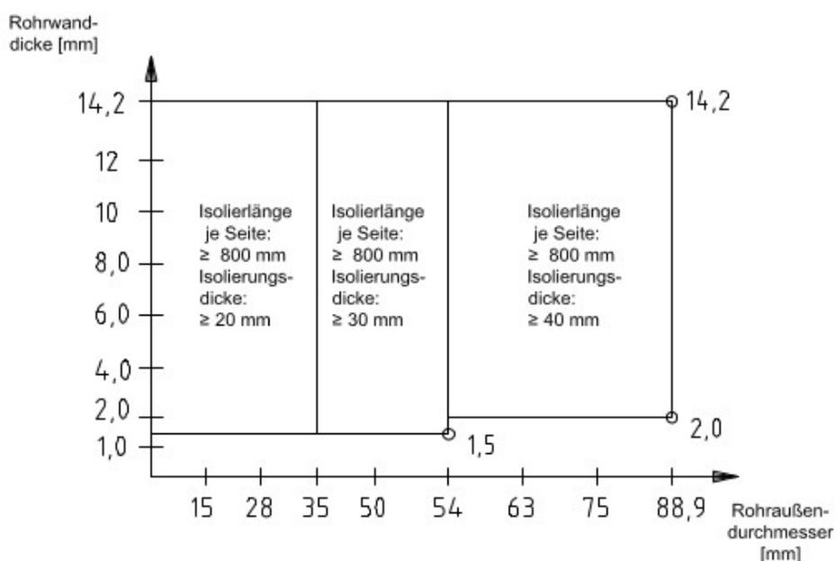
Feuerwiderstandsfähige Abschottung für elektrische Leitungen und Rohrleitungen aus Metall "Hilti Brandschutz-System CFS-BL P-Q"
