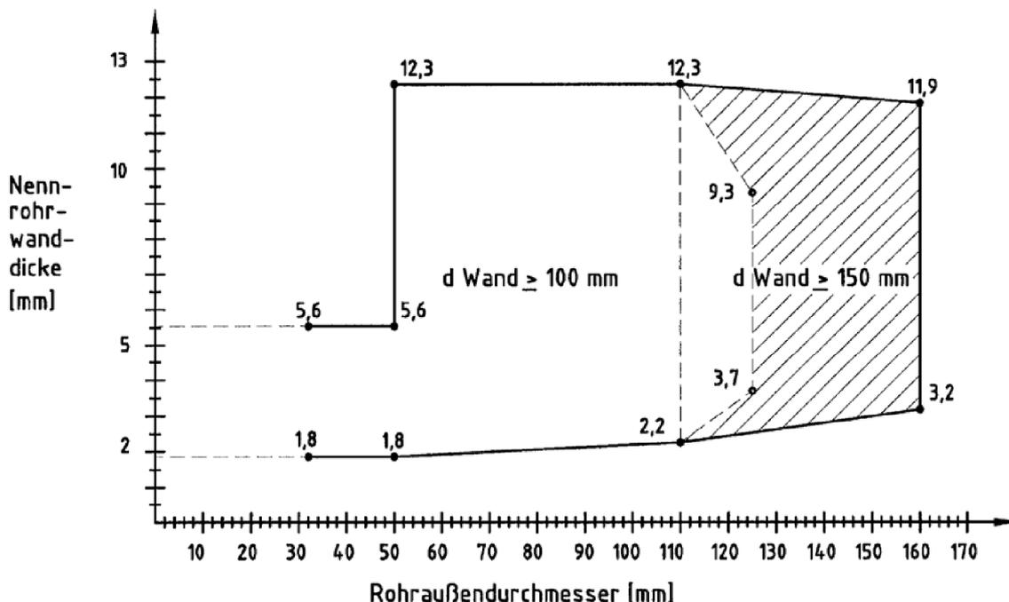
**Rohre gemäß der Rohrgruppe B-2 (Rohre aus PE-HD, LDPE, PP, ABS, ASA, PE-X, PB, ...)**
