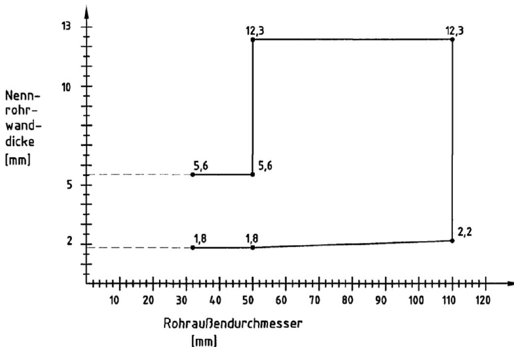
**Rohre gemäß der Rohrgruppe B-1 (Rohre aus PE-HD, LDPE, PP, ABS, ASA, PE-X, PB, ...):
