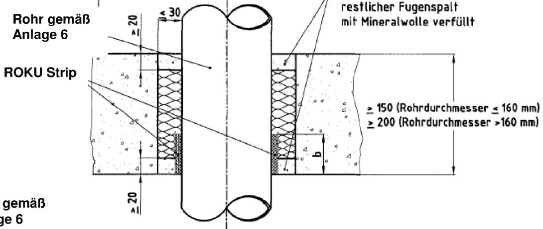
Mörtel ca. 20 mm tief, restlicher Fugenspalt mit Mineralwolle verfüllt
