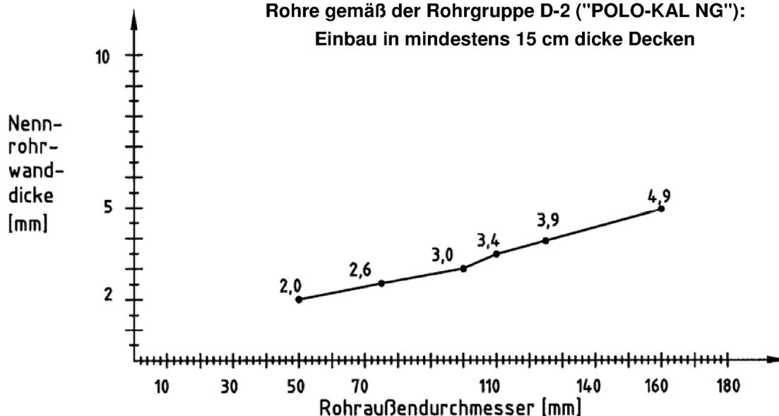
Bei benachbarten Abschottungen nach dieser allg. Bauartgenehmigung muss der Abstand zu anderen Umwicklungen aus dem dämmschichtbildenden Baustoff "ROKU-Strip" bei diesen Rohren mindestens 10 cm betragen.
