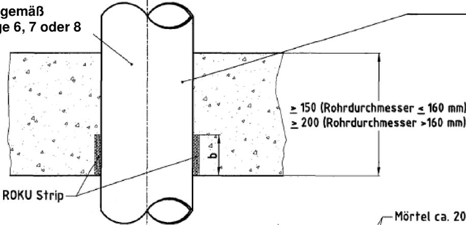
Bei dieser Variante der Fugenverfüllung darf ggf. ein Weichschaum-Streifen ( $d \leq 5 \text{ mm}$ ) eingebaut werden; (s. Anlagen 4 bis 8 und Abschnitt 2.5.4.3); Abstand zwischen benachbarten Umwicklungen dann  $\geq 100 \text{ mm}$
