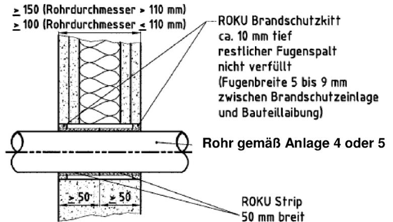
Einbau in leichte Trennwände  $d > 100$  mm und Wände nach ABP s. Anlage 11
