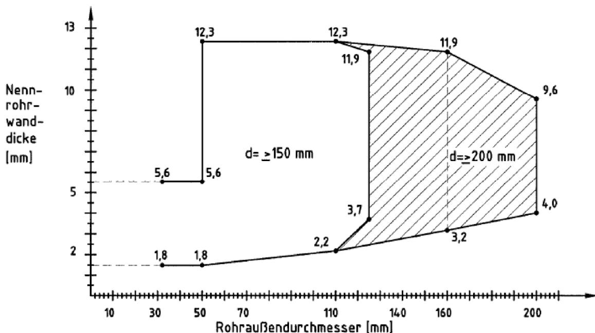
**Rohre gemäß der Rohrgruppe B-3 (Rohre aus PE-HD, LDPE, PP, ABS, ASA, PE-X, PB, ...)**
