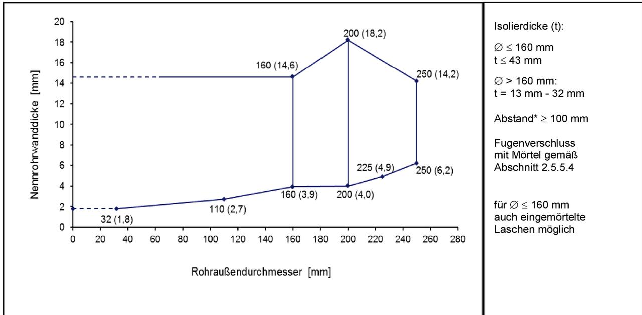
– Einbau in min. 200 mm dicke Decken –
