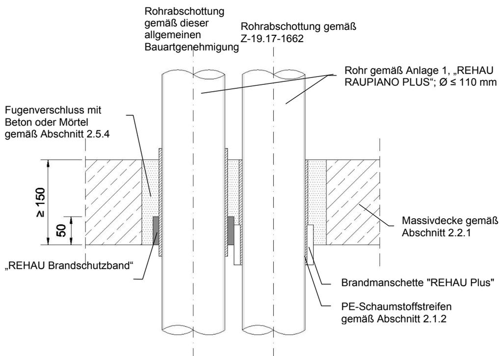
**Deckeneinbau – Abstand zu Rohrabschottungen gemäß P-3725/4130-MPA BS bzw. P-3494/1820-MPA BS**
