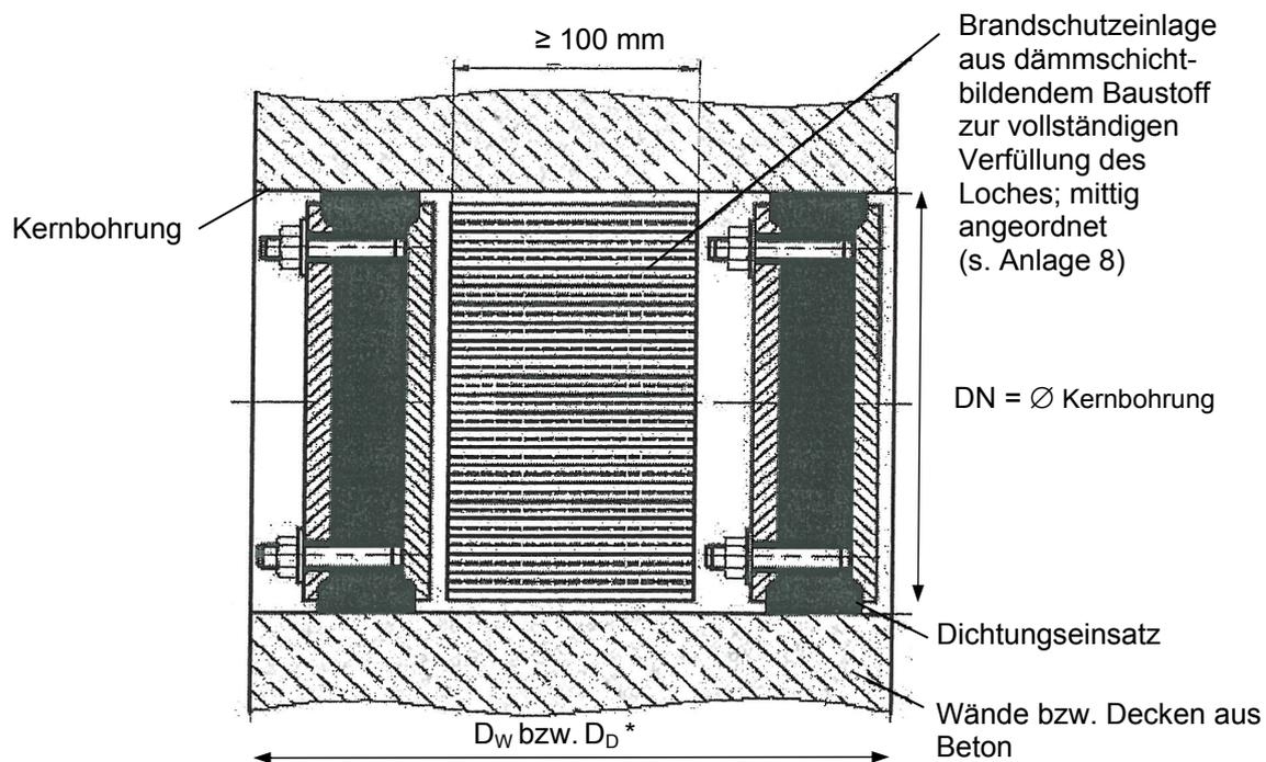
\* Bei DN < 125 mm: Wanddicke  $D_W$  bzw. Deckendicke  $D_D \geq 175$  mm;
