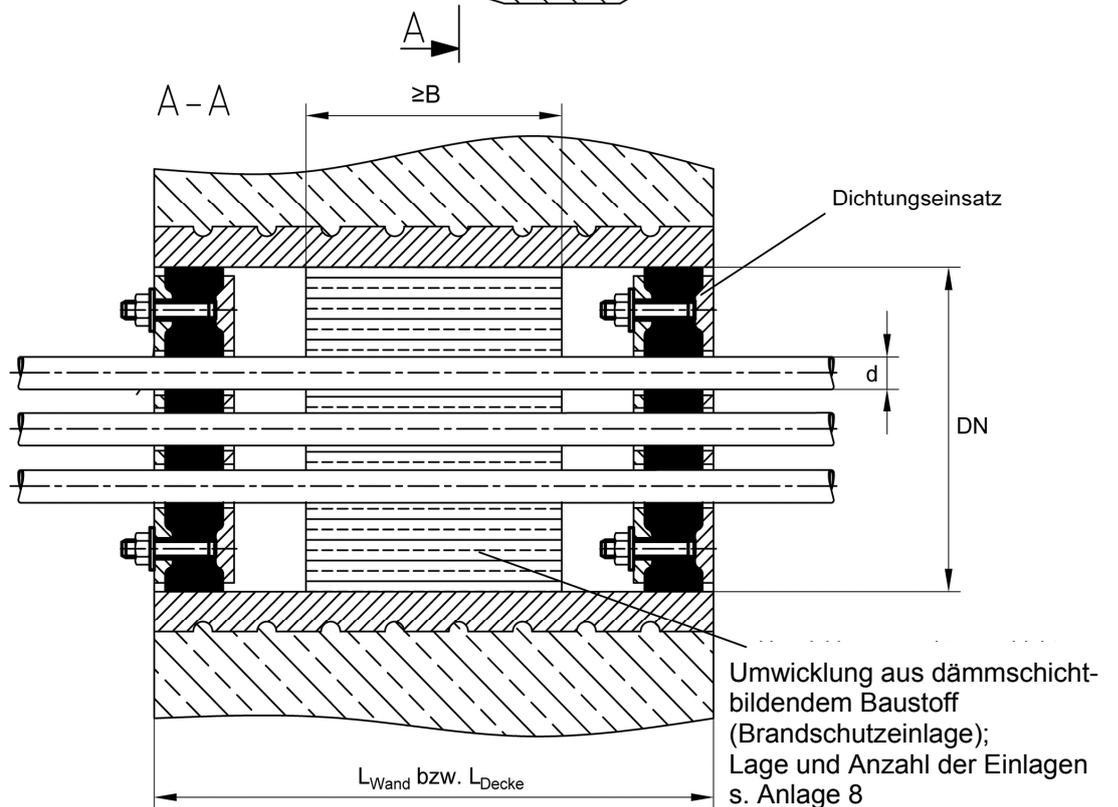
d, DN und B sowie  $L_{Wand}$  bzw.  $L_{Decke}$  (abhängig von Rohrart und -durchmesser sowie Bauteildicke) s. Anlage 8
