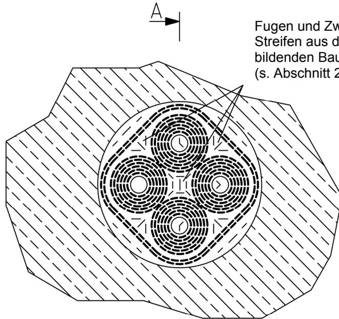
Fugen und Zwickel mit schmalen Streifen aus dem dämmschichtbildenden Baustoff verfüllen (s. Abschnitt 2.5.5.3)
