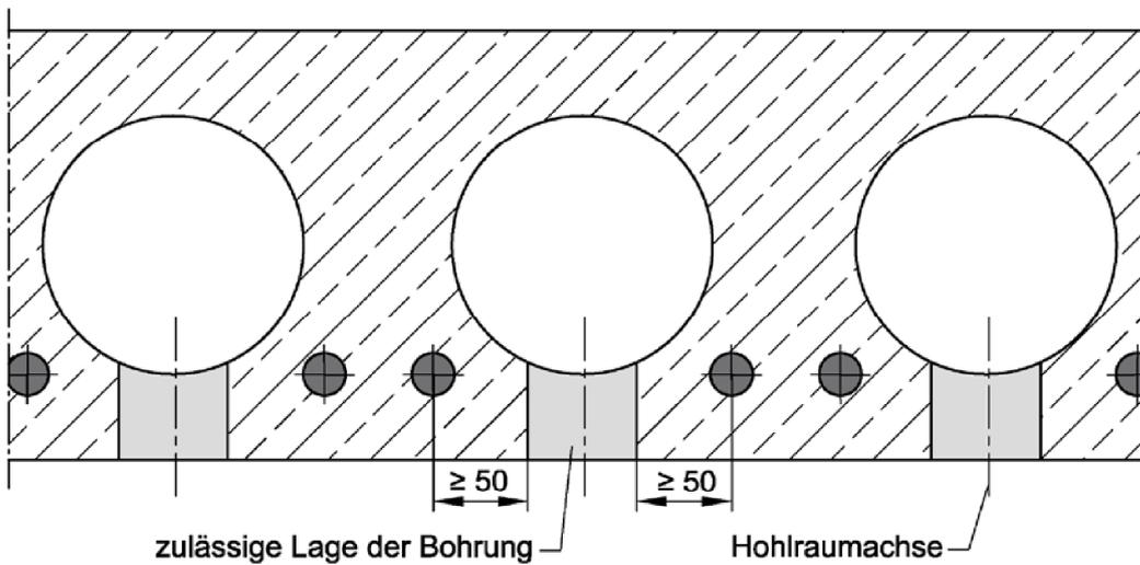
Wird der Dübel nicht mittig in die Hohlraumachse gesetzt, so muss der Abstand zwischen der Dübelachse und der Achse der Spannlitze mindestens 50 mm betragen, entsprechend der o.g. Darstellung. Der Dübel kann sowohl im Vollmaterial der Hohlplatte, als auch von oben in die Hohlplatte eingebaut werden.
